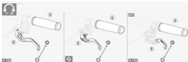
Afbeelding 42: Grijpafstand Magura schijfremhendel afstellen
