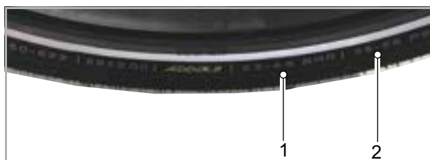
137. ábra: Guminyomás bar-ban (1) és psi-ben (2)
