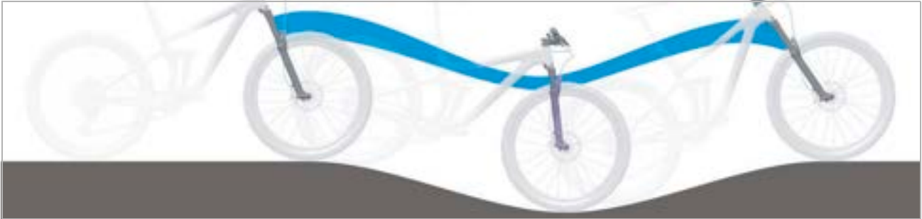
176. ábra: A teleszkópos villa túl puha rugózása hegymenetben
