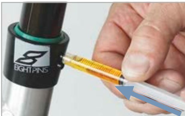
136. ábra: eightpins nyeregcső kenése
