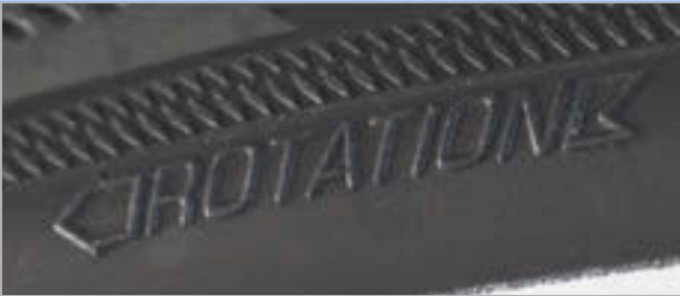
67. ábra: Futásirányjelző nyíl
