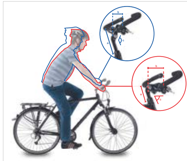
94. ábra: Városi kerékpár (kék) és túrakerékpár (piros) a szög változtatásával
