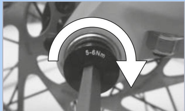
56. ábra: A rögzítőcsavar meghúzása
