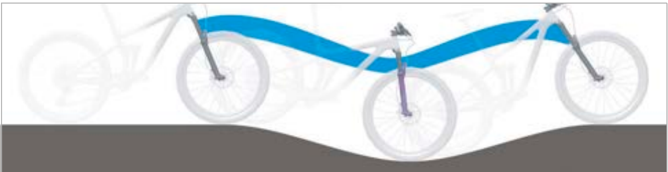
105. ábra: A villa optimális menetviselkedése dombos terepen
