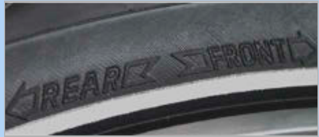
68. ábra: Futásirányjelző nyíl MTB gumiabroncsokon
