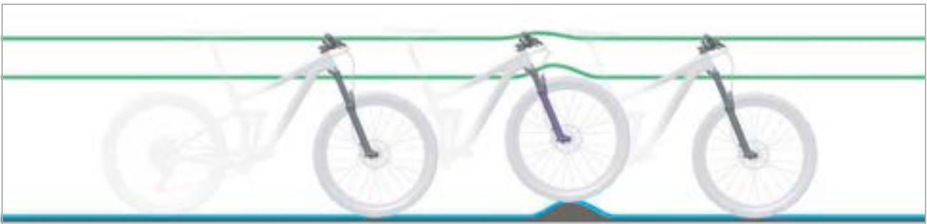
106. ábra: A villa optimális menetviselkedése egyenetlenségek esetén
