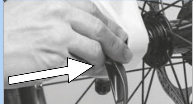
64. ábra: A gyorsár betolása nyilirányban
