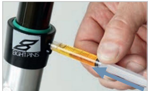
Abbildung 135: eightpins Sattelstütze schmieren
