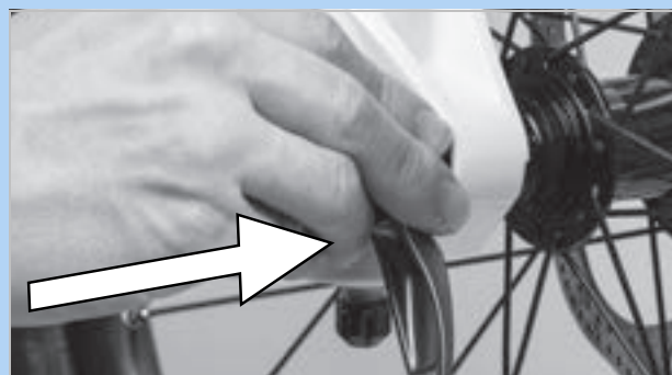
Abbildung 63: Schnellspanner in Pfeilrichtung einschieben
