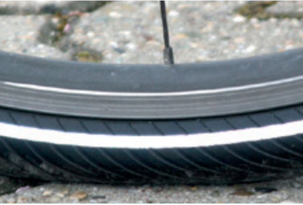
Abbildung 95: Korrekter Fülldruck. Der Reifen ist unter der Last des Körpergewichts kaum verformt.
