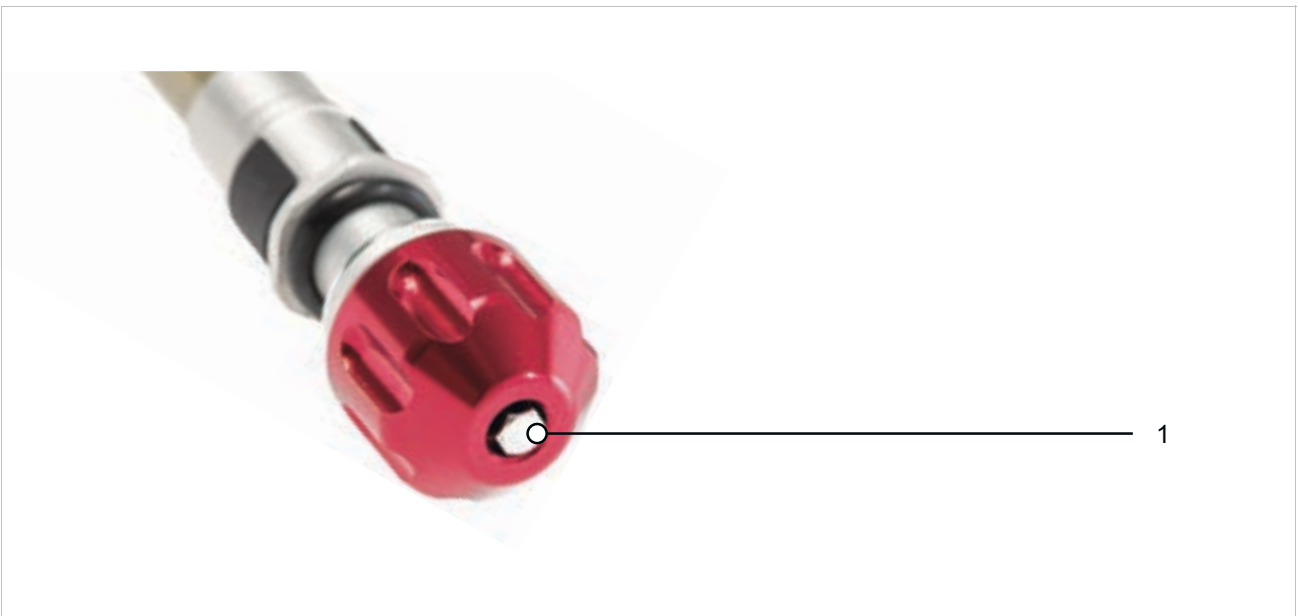
Abbildung 174: Beispiel SR SUNTOUR Zugstufen-Schraube (1)
