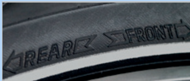
Abbildung 67: Laufrichtungspfeil auf MTB-Reifen
