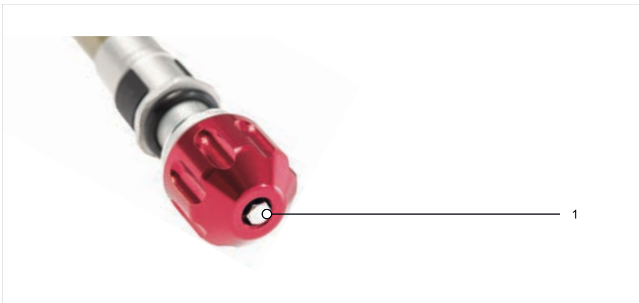
Abbildung 172: Beispiel SR SUNTOUR Zugstufen-Schraube (1)
