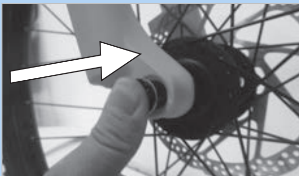
Abbildung 52: Achse in Pfeilrichtung einschieben
