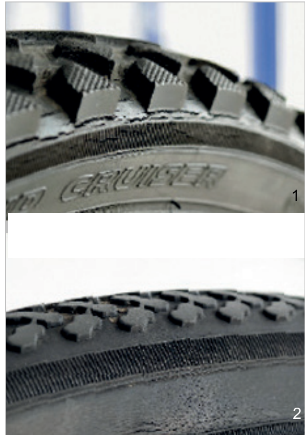
Abbildung 138: Beispiele für Ermüdungsrisse (1) und Alterungsrisse (2)
