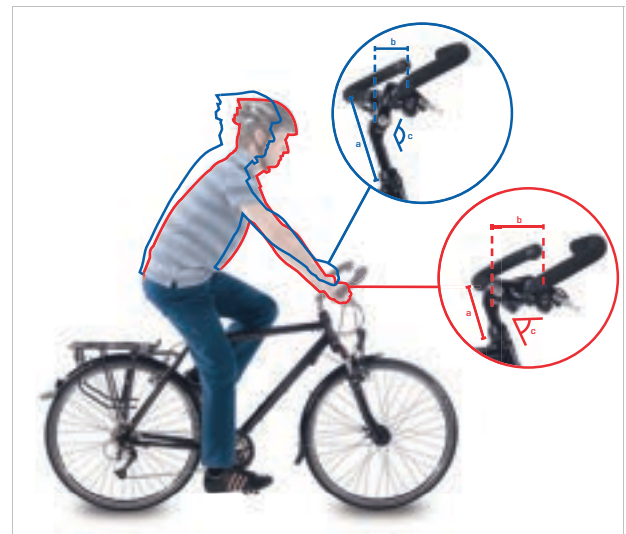
Abbildung 93: Citybike (blau) und Trekkingrad Position (rot) durch Winkeländerung
