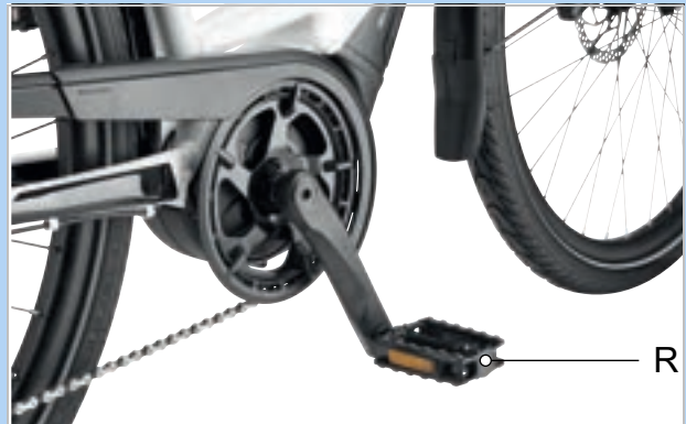
Abbildung 70: R-Pedal im rechten Kurbelarm
