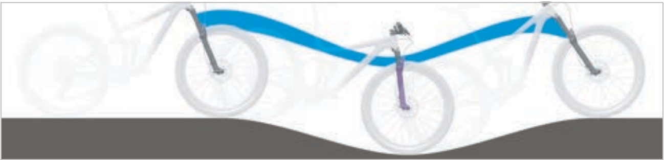
Abbildung 175: Zu weiche Federung der Federgabel am Berg
