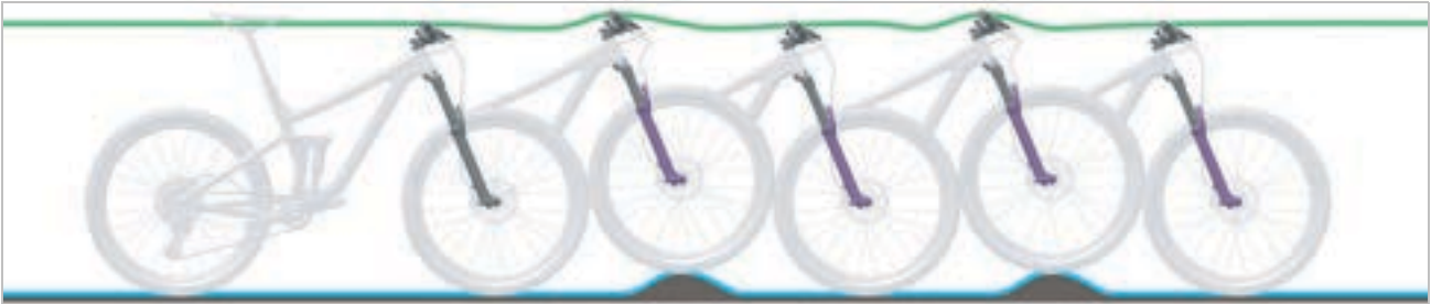
Abbildung 12: Optimales Fahrverhalten der Gabel
