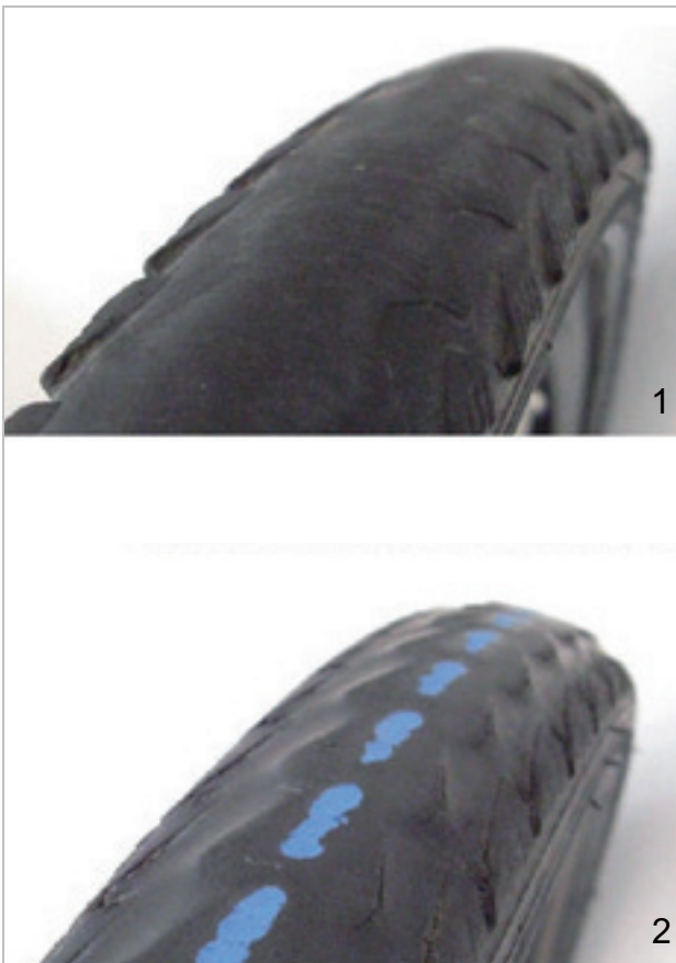
Abbildung 137: Reifen ohne Profil, der gewechselt werden kann (1) und Reifen mit durchscheinendem Pannenschutz (2), der gewechselt werden muss
