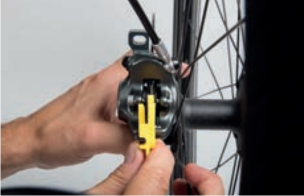
Abbildung 131: Bremsbelag im eingebauten Zustand mithilfe der Transportsicherung prüfen
