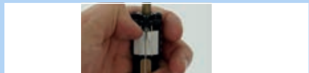
Abbildung 167: Weißer Betätigungsschieber nach unten schieben
