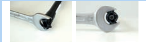
Abbildung 162: Gegen Verdrehen sichern
