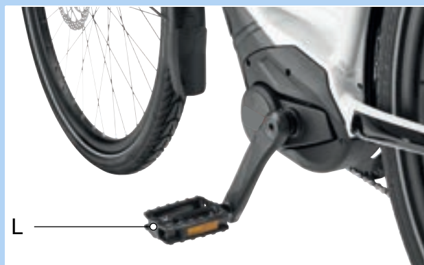
Abbildung 66: L-Pedal im linken Kurbelarm
