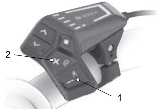
Abbildung 116: Lage Plus-Taster und Minus-Taster
