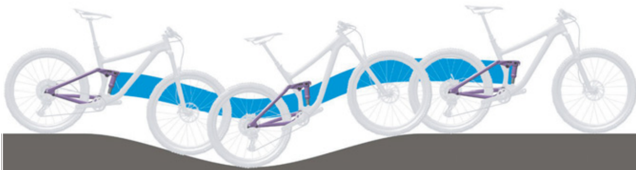
Obr. 68: Optimální chování tlumiče zadního odpružení při jízdě v kopcovitém terénu
