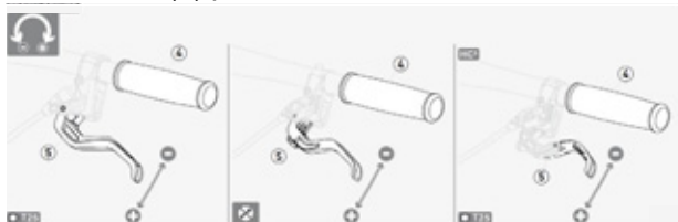
Obr. 51: Nastavení vzdálenosti brzdové páky kotoučové brzdy Magura
