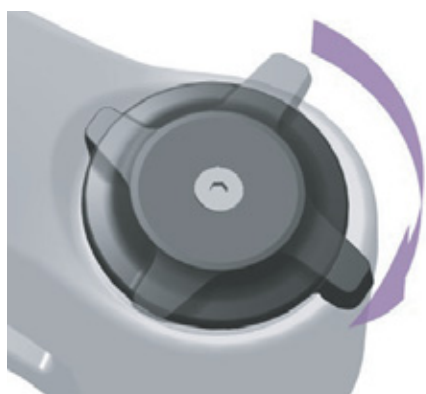
Obr. 94: Tvrdé nastavení nastavovacího šroubu komprese
