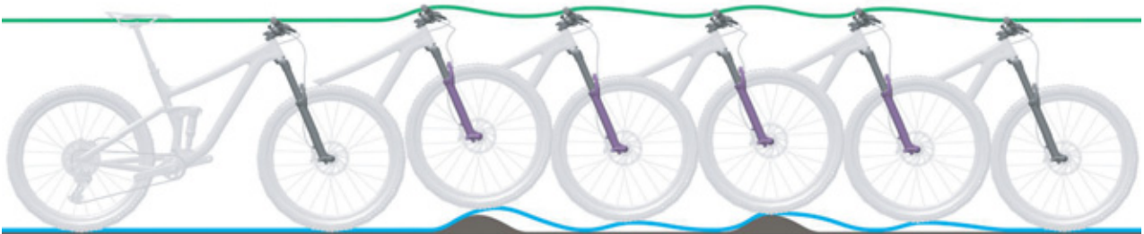
Obr. 89: Příliš rychlé roztahování odpružené vidlice
