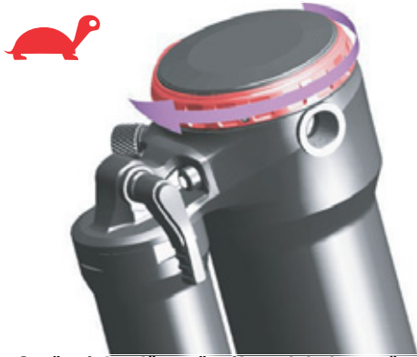
Obr. 98: Otočení tlumiče zpětného odskoku směrem k želvě
