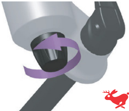
Obr. 92: Otáčení tlumiče zpětného odskoku směrem k zajíci
