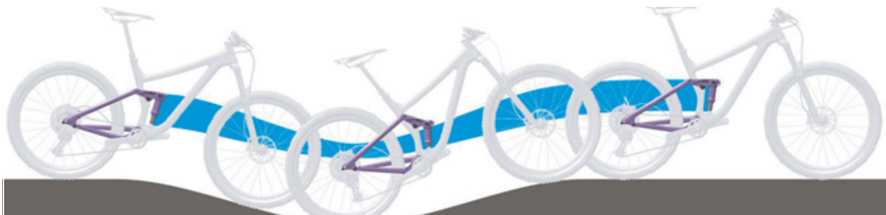
Obr. 101: Příliš měkké odpružení tlumiče zadního odpružení v horách
