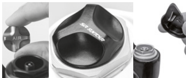
Obr. 54: Sroubovací krytka může mít různé provedení
