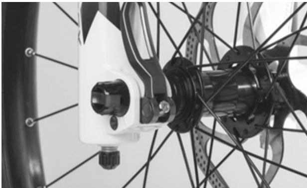
Obr. 84: Nastavení upínací síly rychloupínáku
