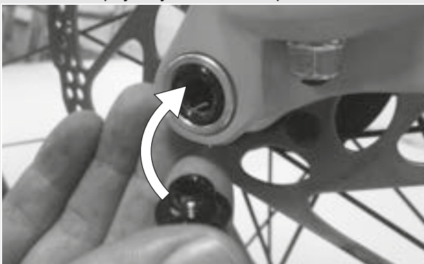
Obr. 24: Zasuňte páku rychloupínáku do osy
