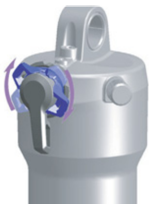
Obr. 102: Tvrdé nastavení nastavovacího šroubu komprese
