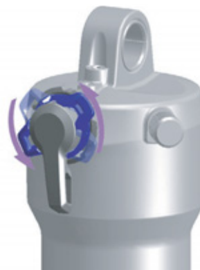
Obr. 72: Měkké nastavení nastavovacího šroubu komprese
