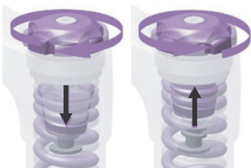
Obr. 55: Otáčení nastavovacím kroužkem předpětí dovnitř a ven
