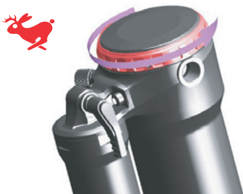
Obr. 100: Otáčení tlumiče zpětného odskoku směrem k zajíci
