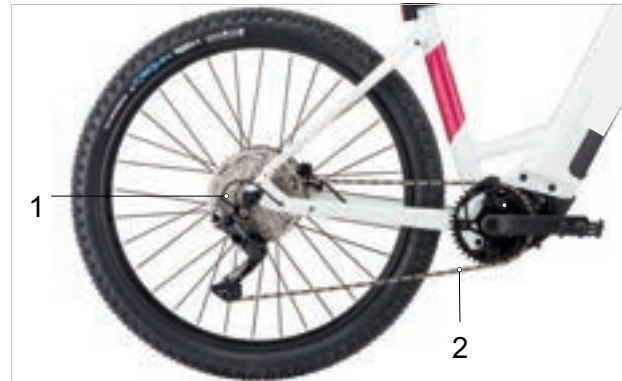
Illustration 48 : Schéma de l'entraînement à chaîne avec dérailleur
