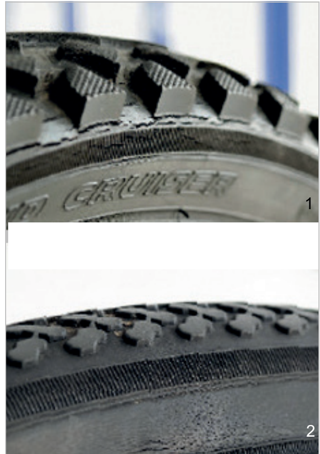
Illustration 186 : Exemples de fissures de fatigue (1) et de fissures d'âge (2)
