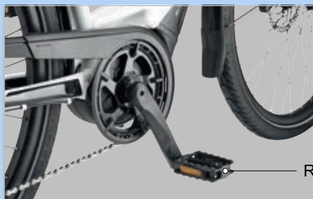
Illustration 101 : Pédale R dans le bras de manivelle droit
