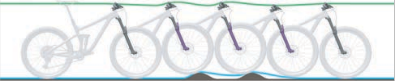
Illustration 221 : Détente trop lente de la fourche suspendue
