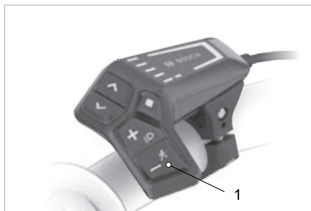
Illustration 167 : Position de la touche d'assistance de poussée (1)
