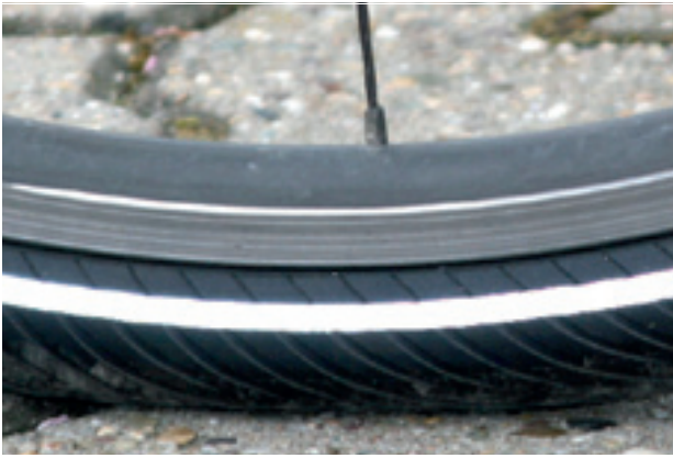
Illustration 126 : Pression correcte. Le pneu se déforme à peine sous le poids du corps.
