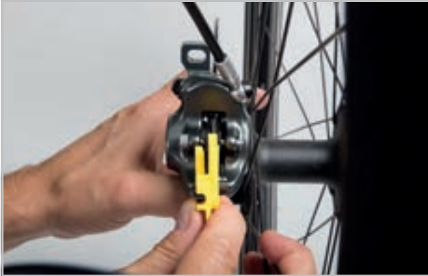
Illustration 187 : Contrôler la plaquette de frein montée à l'aide de la cale de transport
