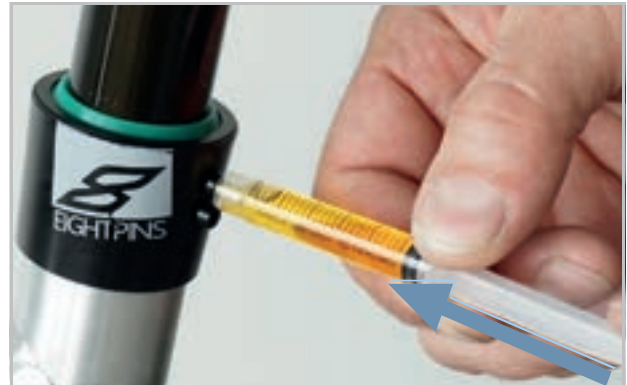
Illustration 183 : Lubrifier une tige de selle eightpins
