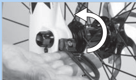
Illustration 90 : Enfoncez le levier d'attache rapide dans le sens de la flèche
