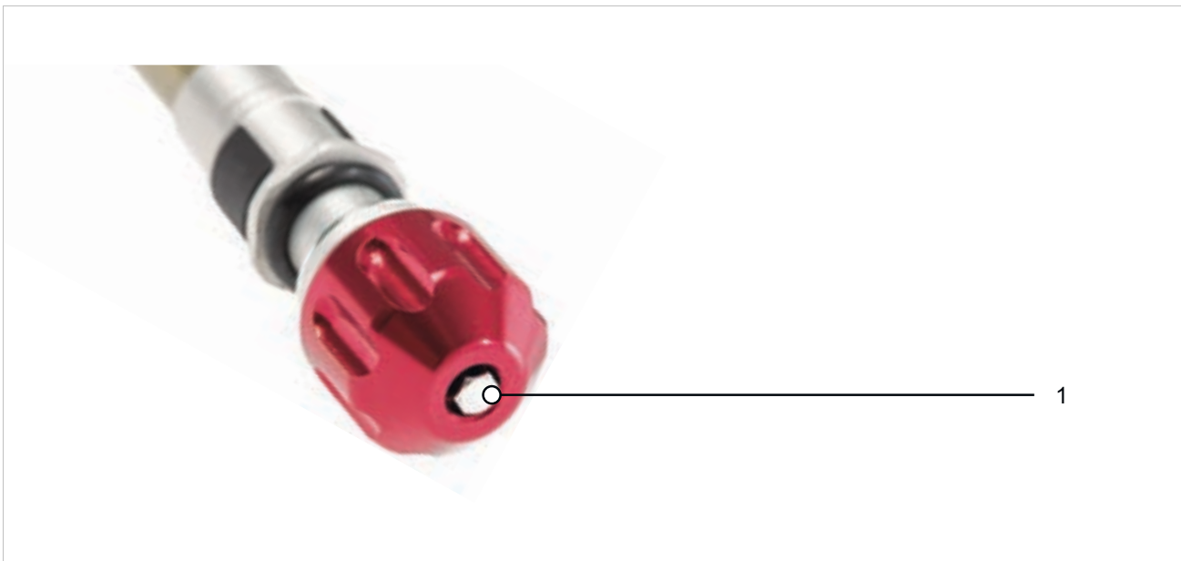
Illustration 222 : Exemple d'une vis de détente SR SUNTOUR (1)
