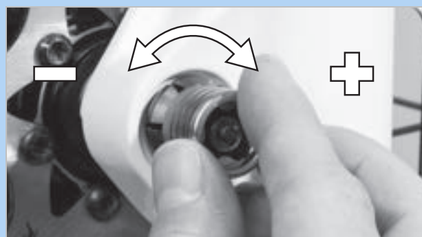
Illustration 95 : Régler la force de serrage
