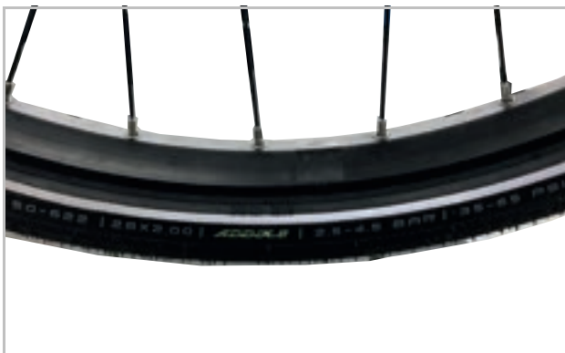
Illustration 26 : Exemple : Informations sur le pneu
