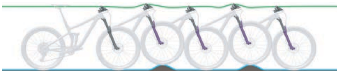
Illustration 140 : Comportement optimal de la fourche
