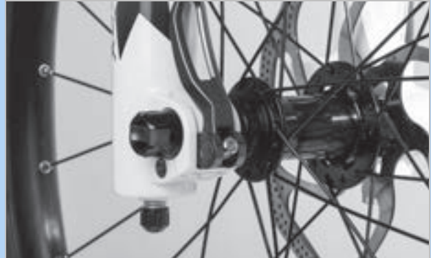
Illustration 215 : Régler la force de serrage de l'attache rapide
