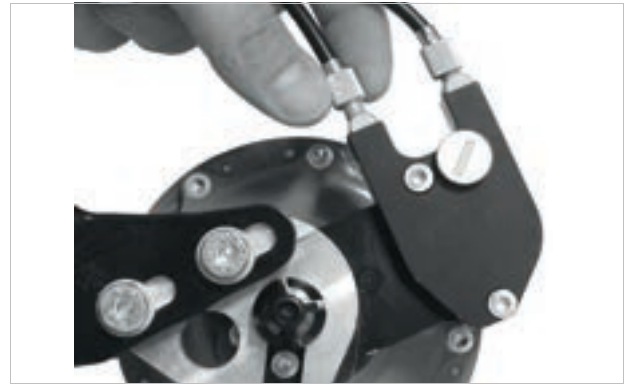
Illustration 212 : Sur les versions de moyeux ROHLOFF avec commande externe du changement de vitesse, le dispositif de réglage de la tension est situé sur le boîtier de câbles qui est placé sur le côté gauche.
