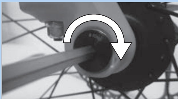
Illustration 84 : Serrer l'axe dans le sens de la flèche
