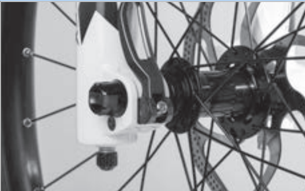
Illustration 91 : Position parfaite du levier de serrage
