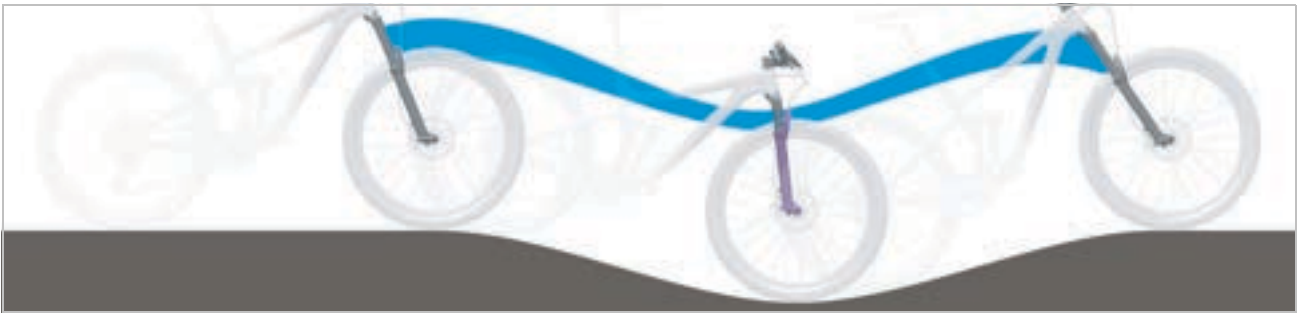
Illustration 223 : Suspension trop souple de la fourche suspendue dans les côtes
