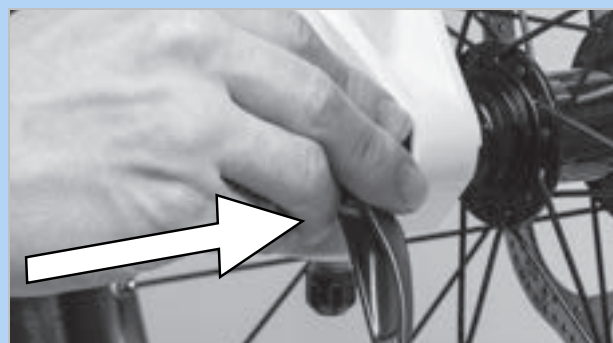
Illustration 94 : Enfoncez l'attache rapide dans le sens de la flèche
