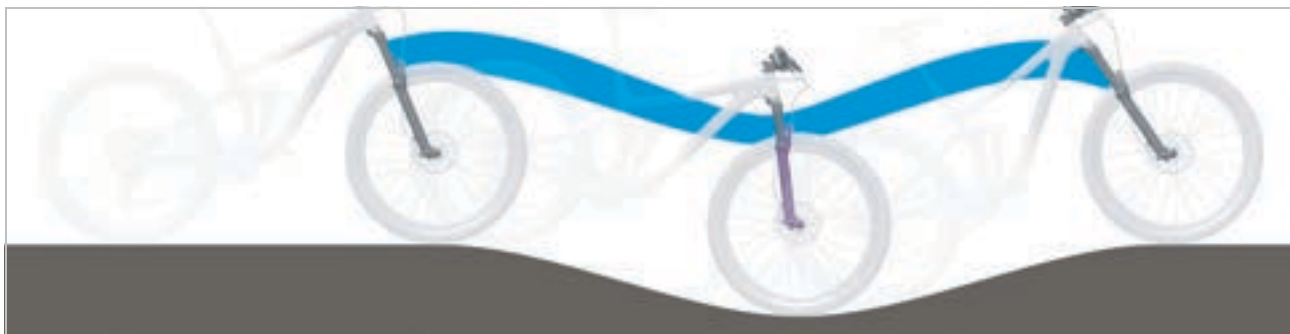
Illustration 137 : Comportement optimal de la fourche en terrain vallonné
