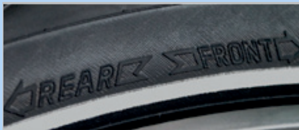
Illustration 98 : Flèche directionnelle sur les pneus VTT
