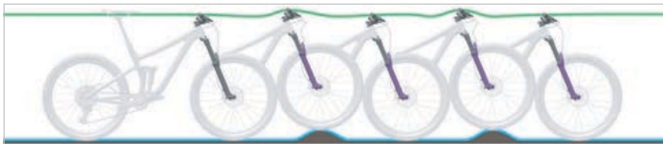
Illustration 136 : Comportement optimal de la fourche
