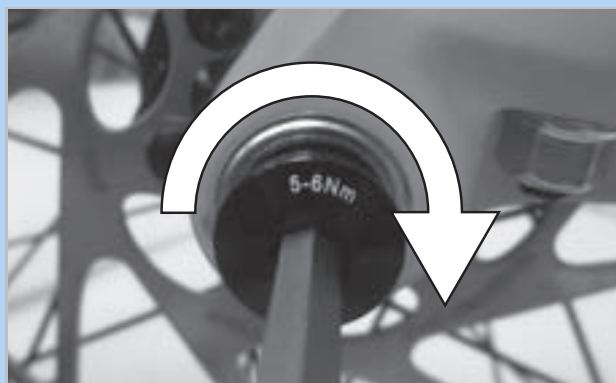
Illustration 86 : Serrer la vis de blocage
