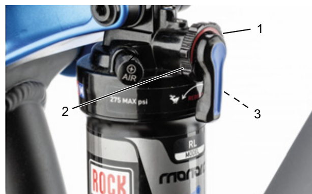
Figura 79: Regolazione della rigidità dell'ammortizzatore a stadi di trazione con la manopola di regolazione (1) dell'ammortizzatore del carro posteriore
