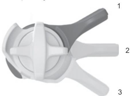
Figura 74: Regolatore della compressione FOX sull'ammortizzatore del carro posteriore con le posizioni APERTO (1), MEDIO (2) e RIGIDO (3)
