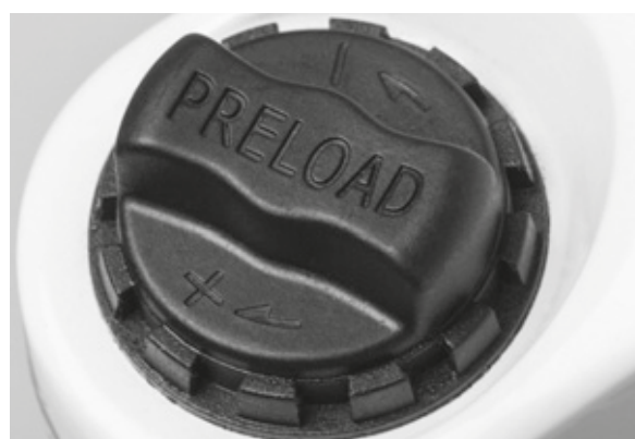
Figura 58: Manopola di regolazione dell'escursione negativa della sospensione sulla corona della forcella ammortizzata
