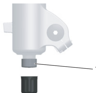
Figura 60: Regolatore del rebound FOX (1) sulla forcella
