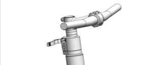
Illustration 233 : Exemple d'un All Up avec levier de serrage de la potence ouvert
