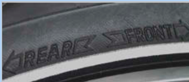
Illustration 115 : Flèche directionnelle sur les pneus VTT
