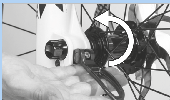
Illustration 123 : Enfoncez le levier d'attache rapide dans le sens de la flèche
