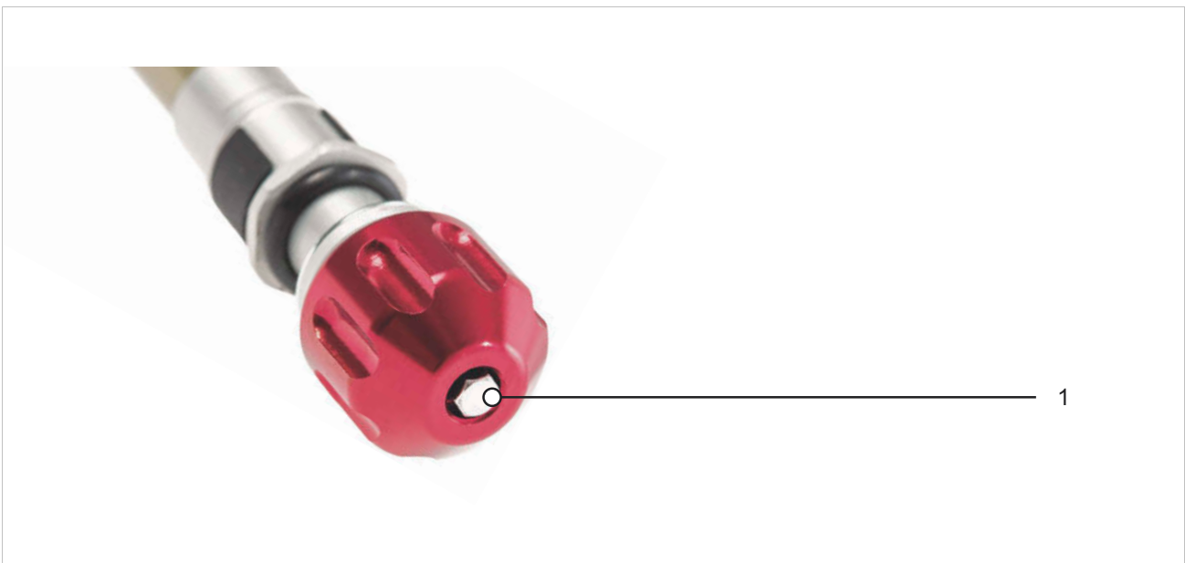
Illustration 279 : Exemple d'un réglage de détente SR SUNTOUR (fourche) (1)
