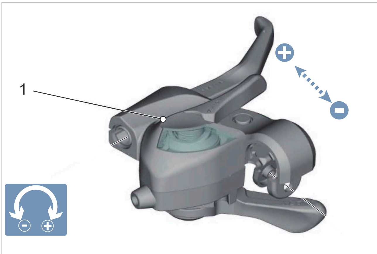
Illustration 166 : Position de la vis de réglage (1)
