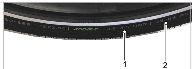
Illustration 239 : Indication de pression des pneus en bar (1) et psi (2)
