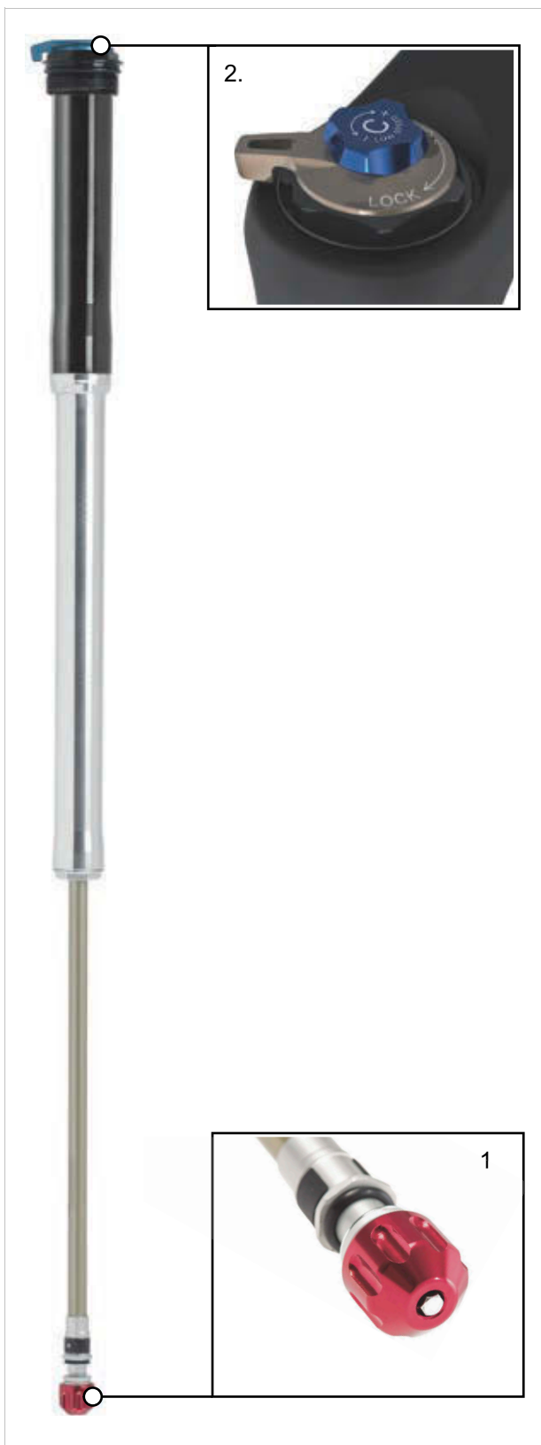
Illustration 20 : Éléments de commande de la cartouche LO
