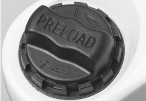
53. ábra: Az SAG (negatív rugóút) beállító kereke a teleszkópos villa koronáján
