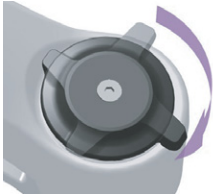
78. ábra: A nyomásfokozat-beállító keményebb beállítása
