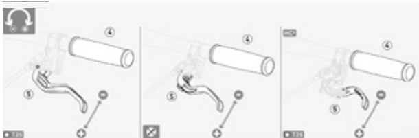
51. ábra: Magura tárcsafék fékkar markolási szélességének beállítása
