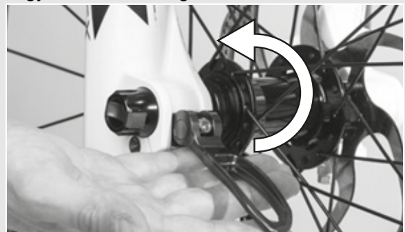
31. ábra: A kar rögzítése
