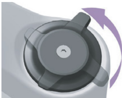
79. ábra: A nyomásfokozat-beállító puhább beállítása
