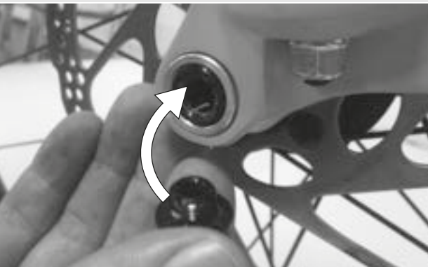
24. ábra: A gyorskioldó kar betolása a tengelybe
