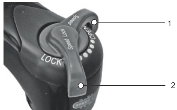
77. ábra: Suntour nyomásfokozat-lengéscsillapító nyitott (1) és zárt (2) helyzetben
