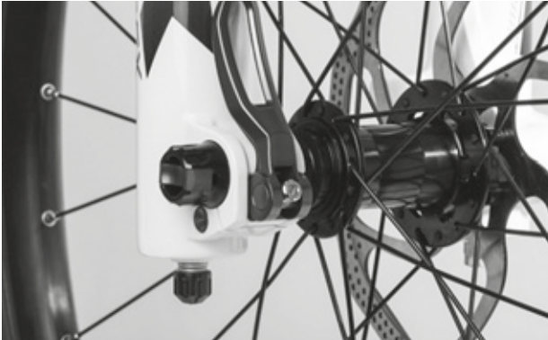
32. ábra: A gyorskioldó kar tökéletes helyzete
