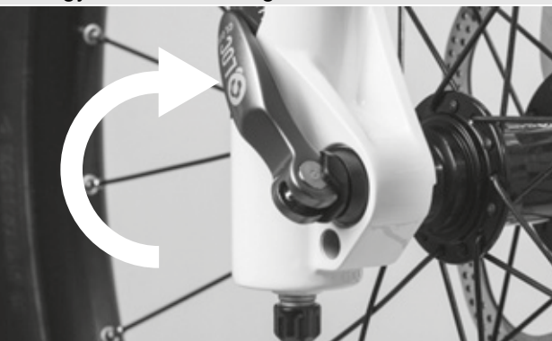
37. ábra: A gyorszár zárása
