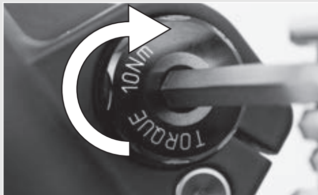
Abbildung 23: Eingesetzte Achse festziehen
