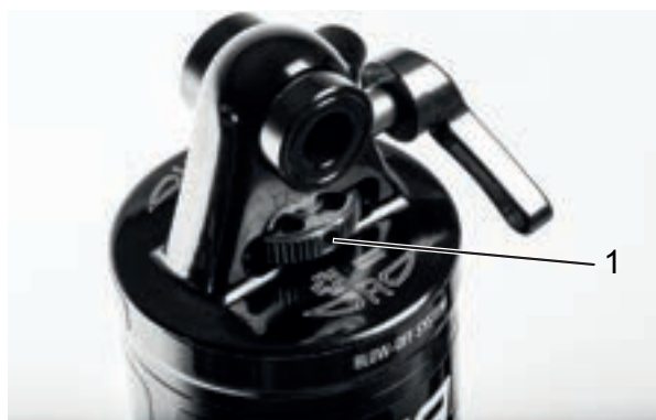
Abbildung 55: Suntour-Zugstufeneinsteller Rad(1) am Hinterbau-Dämpfer
