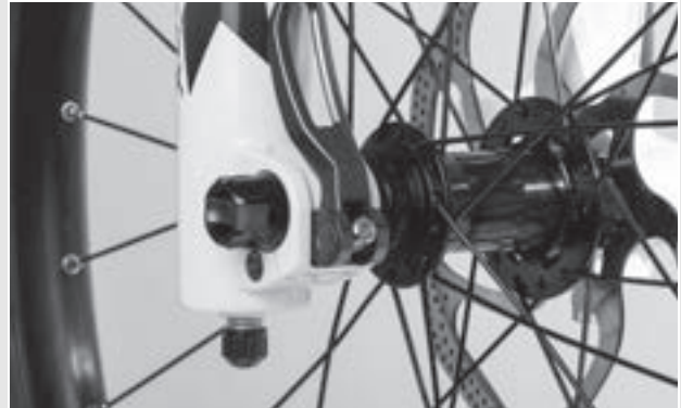
Abbildung 83: Spannkraft des Schnellspanners einstellen
