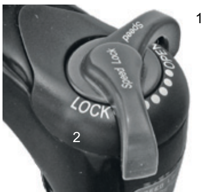
Abbildung 79: Suntour-Druckstufeneinsteller mit den Positionen OPEN (1) und LOCK (2)
