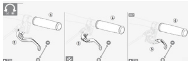
Figura 62: Regolazione dell'ampiezza di presa della leva del freno Magura con freno a disco
