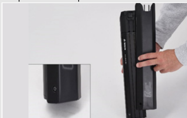
Figura 34: Applicazione della copertura della batteria sulla batteria
