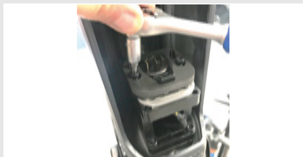
Figura 22: Svitamento delle viti del portabatteria
