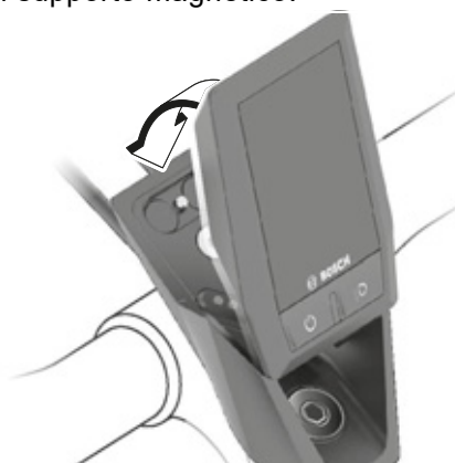
Figura 71: Inclinazione del computer di bordo
