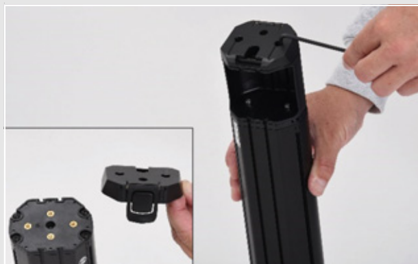
Figura 33: Avvitamento della piastra di montaggio della batteria
