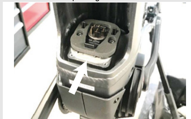
Figura 26: Piastre dell'adattatore incorporate
