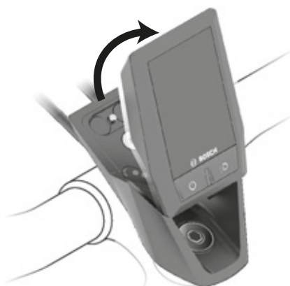
Figura 73: Smontaggio del computer di bordo
