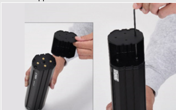
Figura 32: Montaggio della prolunga del PowerTube
