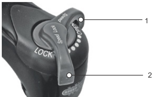
Figura 81: Regolatore dello stadio di pressione Suntour con posizioni OPEN (1) e LOCK (2)
