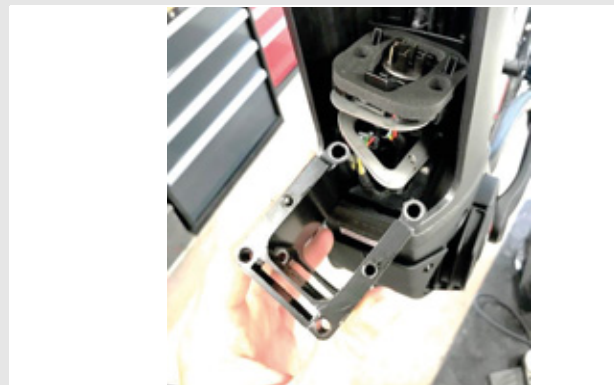
Figura 25: Estrazione dell'adattatore PowerTube
