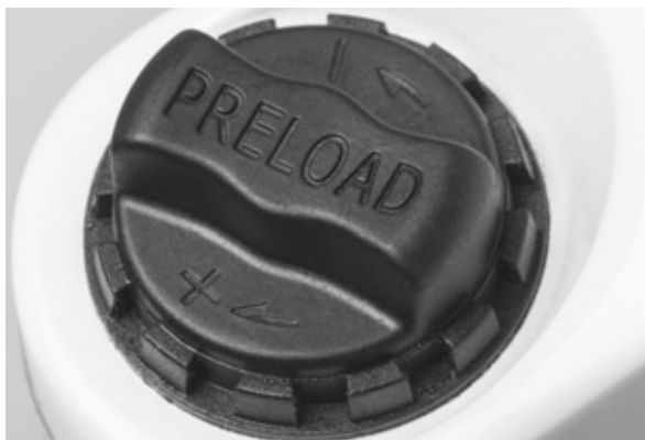
Figura 64: Manopola di regolazione dell'escursione negativa della sospensione sulla corona della forcella ammortizzata
