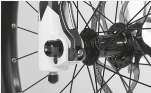
Figura 45: Corretta posizione della leva di serraggio
