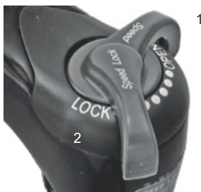
Afbeelding 76: Suntour-drukdemperafsteller met de standen OPEN (1) en LOCK (2)
