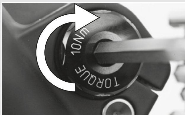
Afbeelding 29: Aangebrachte as vastdraaien
