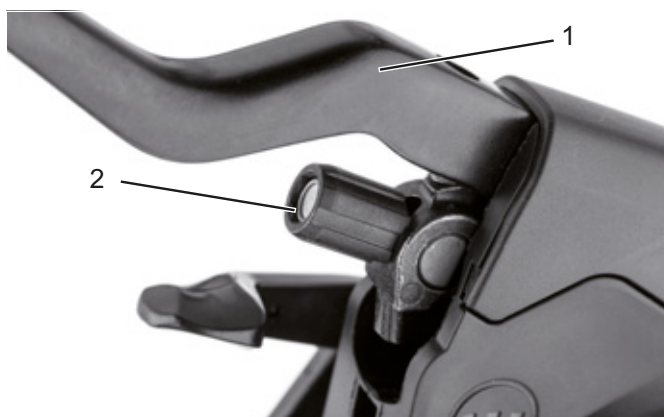
Obr. 67: Brzdová páka (1) hydraulicky ovládaných ráfkových brzd s nastavovacím šroubem (2)
