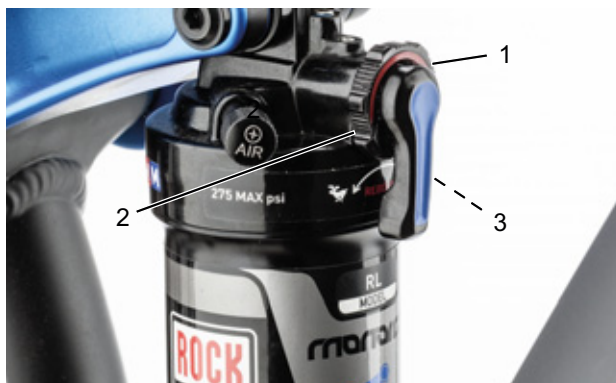
Afbeelding 82: Hardheid van de trekdemper afstellen met het afstelwiel (1) van de achterbouwdemper
