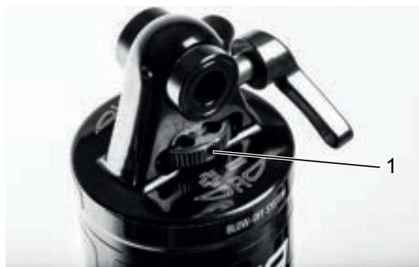
Abbildung 64: Suntour-Zugstufeneinsteller Rad (1) am Hinterbau-Dämpfer
