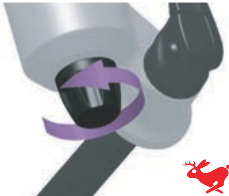
Abbildung 92: Zugstufendämpfer in Richtung Hase drehen
