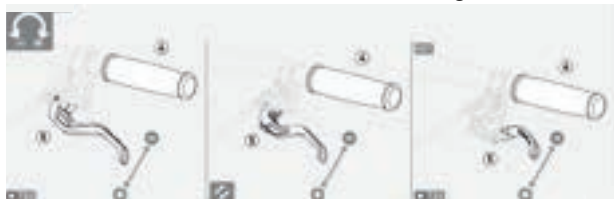
Abbildung 51: Griffweite Bremshebel Magura Scheibenbremse einstellen
