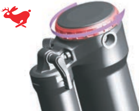
Abbildung 100: Zugstufendämpfer in Richtung Hase drehen
