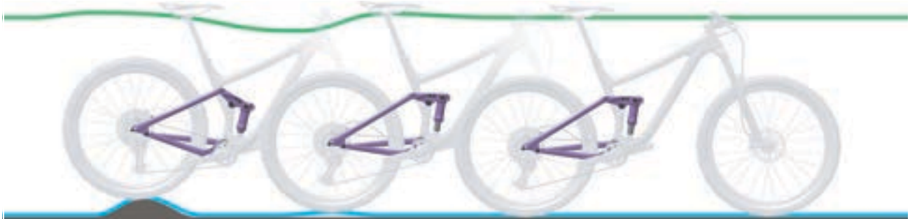
Abbildung 97: Zu schnelles Ausfedern des Hinterbau-Dämpfers
