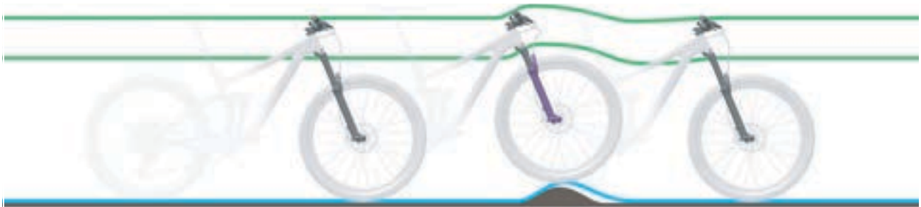
Abbildung 95: Zu harte Dämpfung der Federgabel bei Unebenheiten
