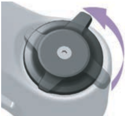
Abbildung 96: Druckstufeneinsteller weicher einstellen
