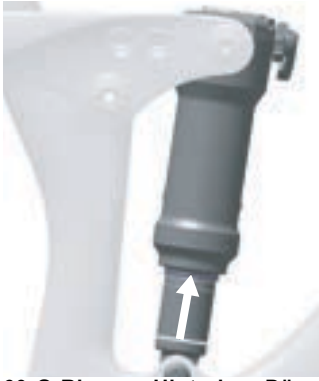
Abbildung 60: O-Ring am Hinterbau-Dämpfer verschoben
