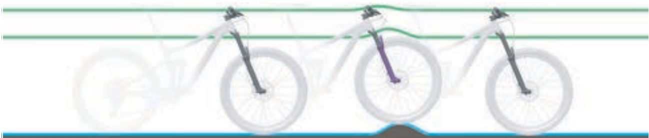
Abbildung 7: Optimales Fahrverhalten der Gabel bei Unebenheiten
