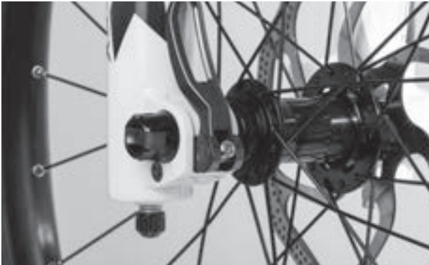
Abbildung 32: Perfekte Lage des Spannhebels
