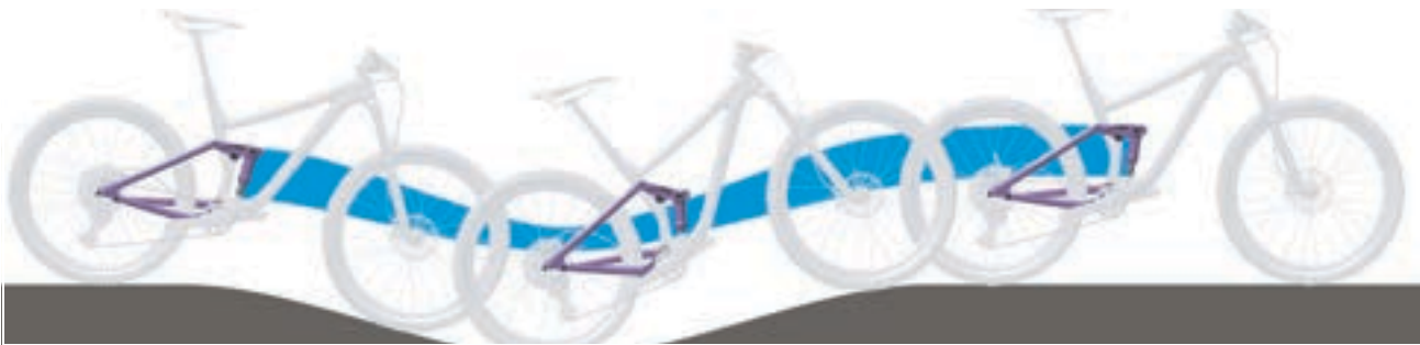
Abbildung 101: Zu weiche Federung des Hintebau-Dämpfers am Berg
