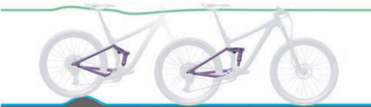
Abbildung 69: Optimales Fahrverhalten des Hinterbau-Dämpfers bei Unebenheiten
