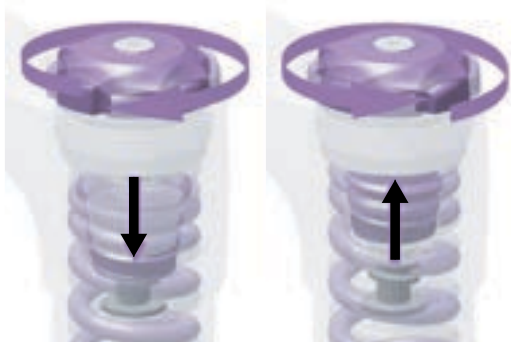
Abbildung 55: Vorspannungseinstellung herein und heraus drehen.
