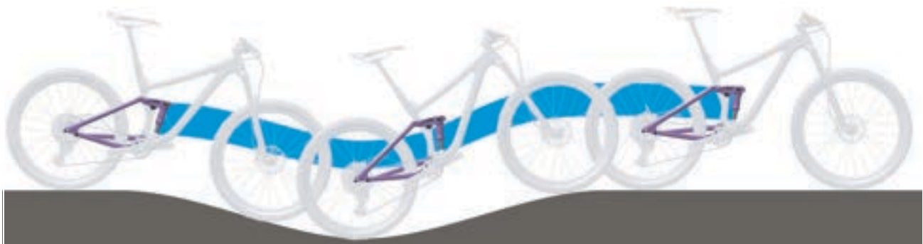
Abbildung 11: Optimales Fahrverhalten des Hinterbau-Dämpfers im hügeligen Gelände
