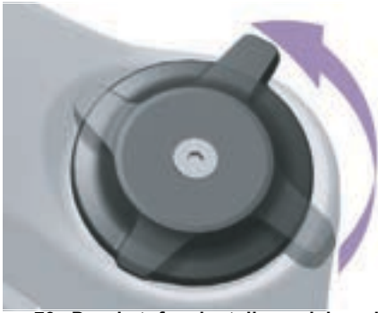
Abbildung 79: Druckstufeneinsteller weicher einstellen
