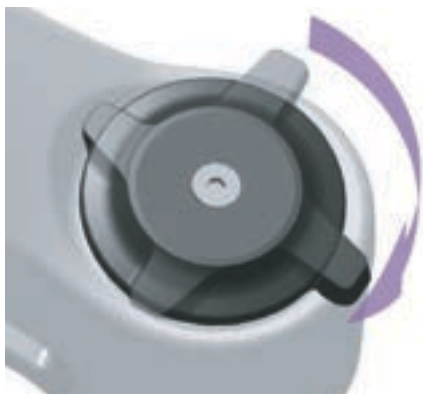
Abbildung 94: Druckstufeneinsteller härter einstellen
