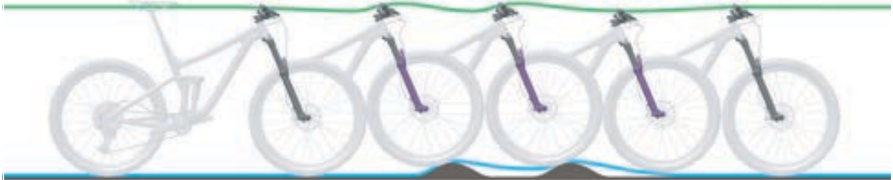
Abbildung 91: Zu langsames Ausfedern der Federgabel
