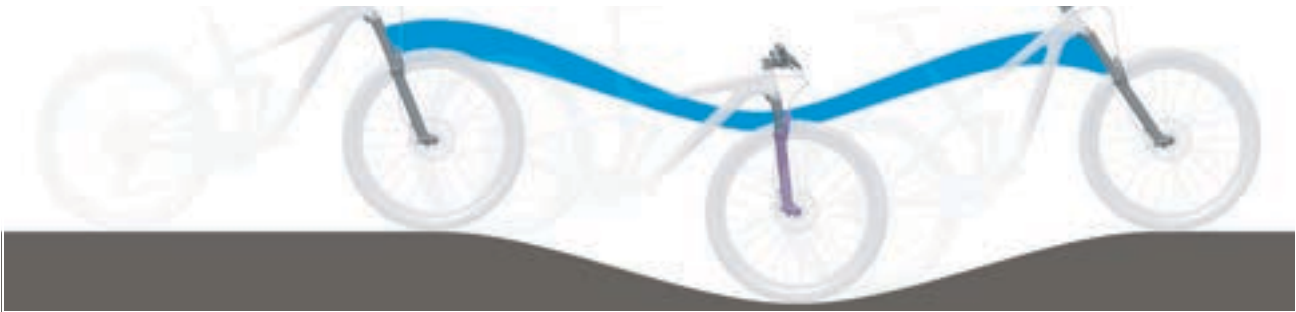
Abbildung 93: Zu weiche Federung der Federgabel am Berg
