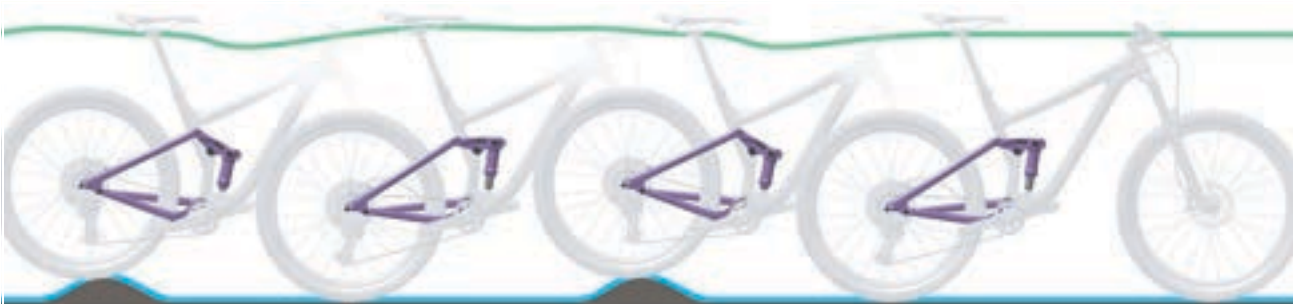
Abbildung 62: Optimales Fahrverhalten des Hinterbau-Dämpfers
