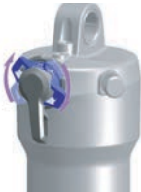
Abbildung 102: Druckstufeneinsteller härter einstellen
