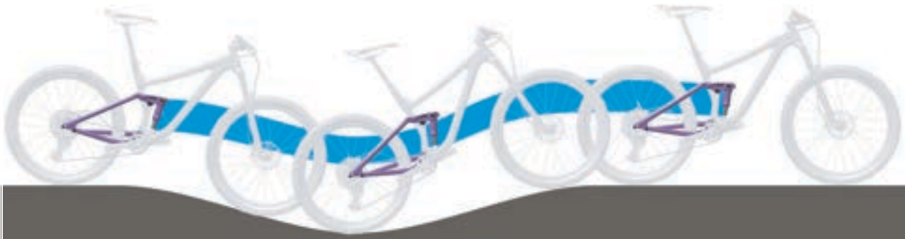
Abbildung 68: Optimales Fahrverhalten des Hinterbau-Dämpfers im hügeligen Gelände
