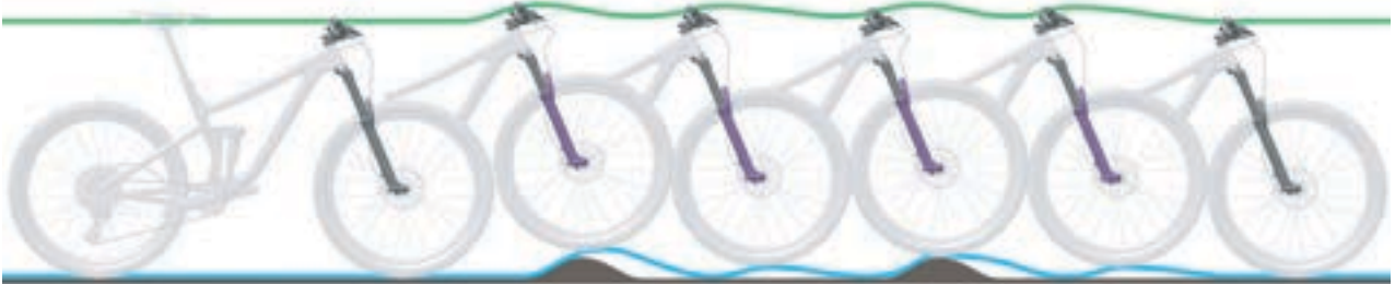
Abbildung 89: Zu schnelles Ausfedern der Federgabel
