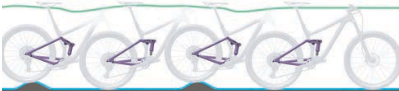
Abbildung 10: Optimales Fahrverhalten des Hinterbau-Dämpfers
