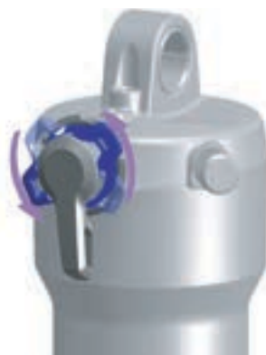
Abbildung 72: Druckstufeneinsteller weicher einstellen
