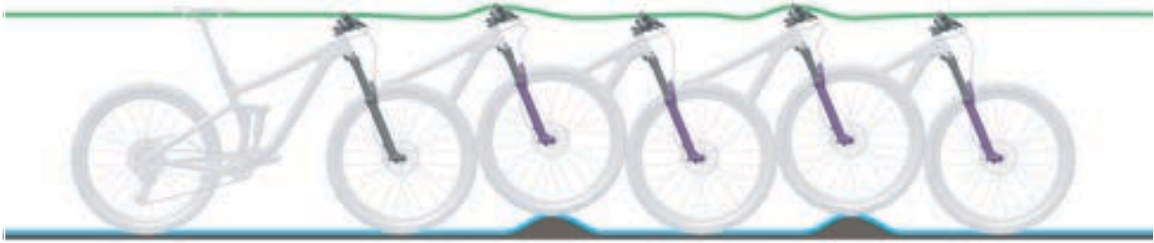
Abbildung 5: Optimales Fahrverhalten der Gabel
