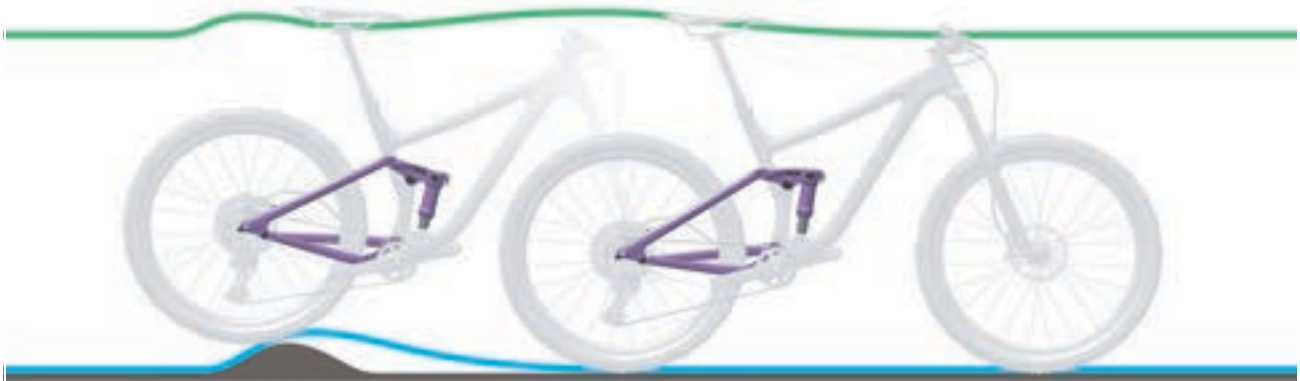
Abbildung 103: Zu harte Dämpfung des Hinterbau-Dämpfers bei Unebenheiten
