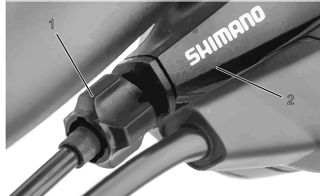
Abbildung 86: Einstellhülse (1) der einzügigen, seilzugbetätigten Gangschaltung mit Schalthebelgehäuse (2), Beispiel
