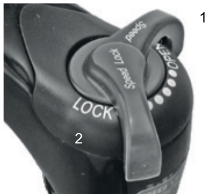
Abbildung 69: Suntour-Druckstufen-Einsteller mit den Positionen OPEN (1) und LOCK (2)
