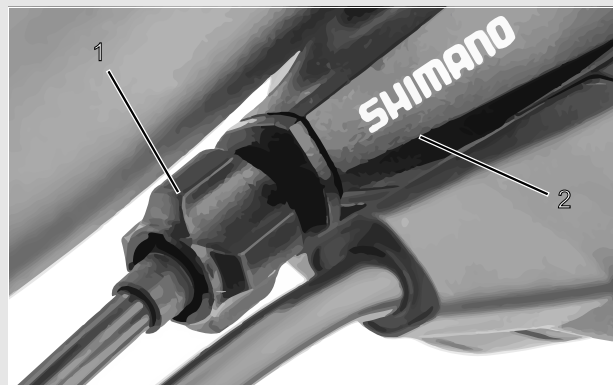
Abbildung 75: Einstellhülse (1) der einzügigen, seilzugbetätigten Gangschaltung mit Schalthebelgehäuse (2), Beispiel
