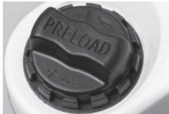
Abbildung 58: Einstellrad des Negativfederwegs auf der Krone der Federgabel
