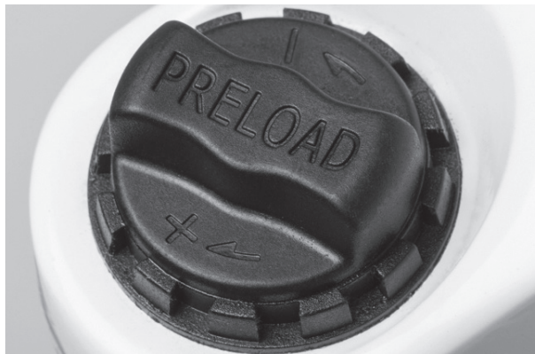
Abbildung 40: Einstellrad des Negativen Federwegs auf der Krone der Federgabel
