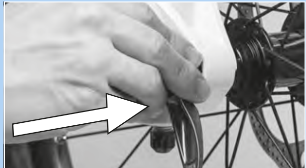
62. ábra: A gyorszár betolása nyírlányban
