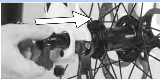
55. ábra: A kereszttengety betolása nyírányban
