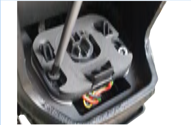
46. ábra: Akkumulátortartó csavarok oldása
