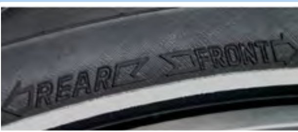
50. ábra: Futásirányjelző nyíl MTB gumiabroncsokon
