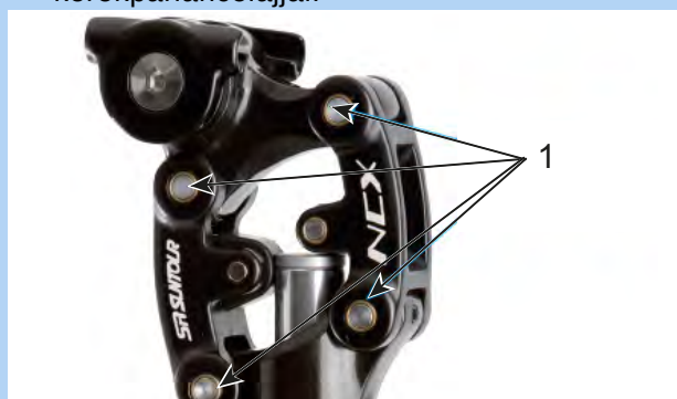
139. ábra: SR kenőpontok Suntour rugós nyeregcső
