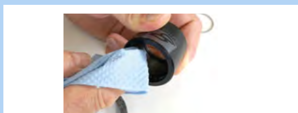
152. ábra: Külső hüvely tisztítása
