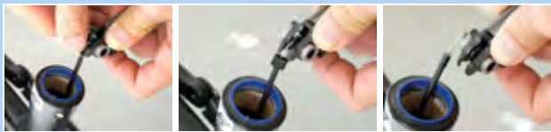
181. ábra: Bovden eltávolítása
