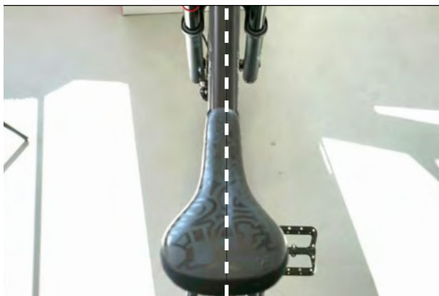
69. ábra: Nyereg beállítása menetirányban
