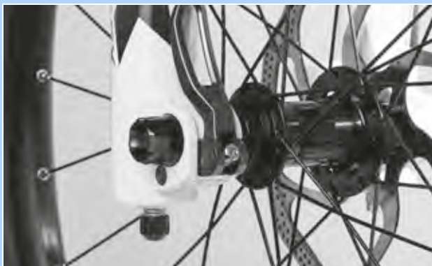
137. ábra: A gyorszár szorítóerejének beállítása
