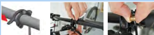
142. ábra: Tubus kiszérése
