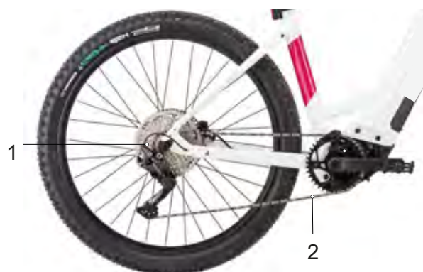
27. ábra: Külső váltóval felszerelt lánchajtás vázlata
