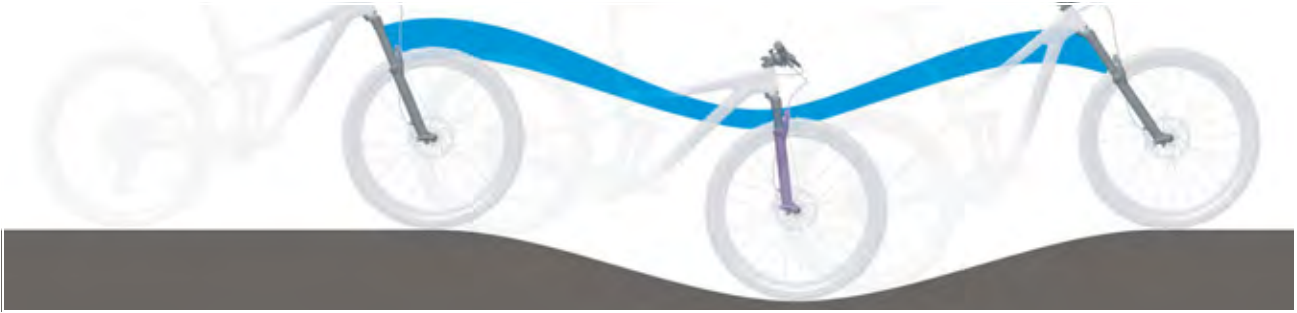
206. ábra: A teleszkópos villa túl puha rugózása hegymenetben
