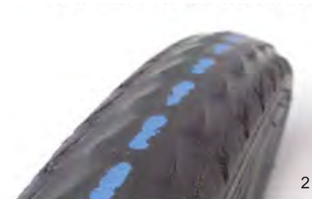
127. ábra: Profil nélküli gumiabroncs, amivel még kerékpározni lehet (1), és cserélendő gumiabroncs áttetsző defektvédelemmel (2)
