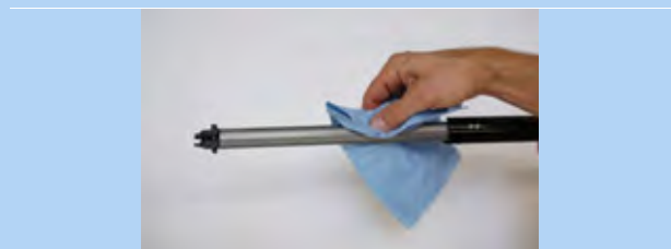
193. ábra: Hosszirányú vezetőhorony tisztítása
