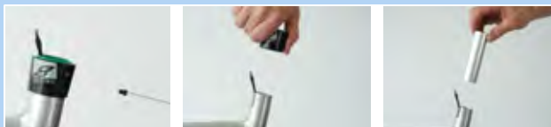
148. ábra: Külső hüvely és siklópersely kiszérése
