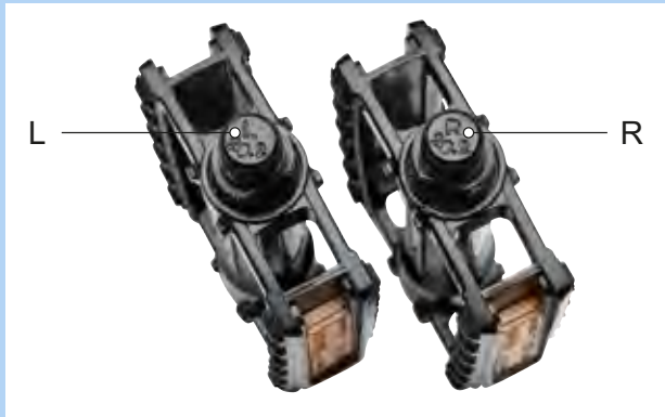
65. ábra: Példa: pedálok jelölése
