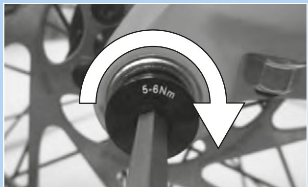
54. ábra: A rögzítőcsavar meghúzása
