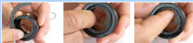
153. ábra: Filcgyűrű behelyezése
