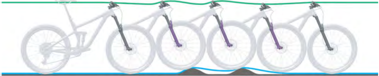
204. ábra: A teleszkópos villa túl lassú kirugózása
