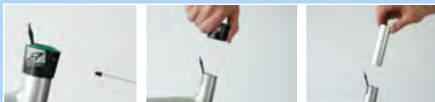
182. ábra: Külső hüvely és siklópersely kiszérése
