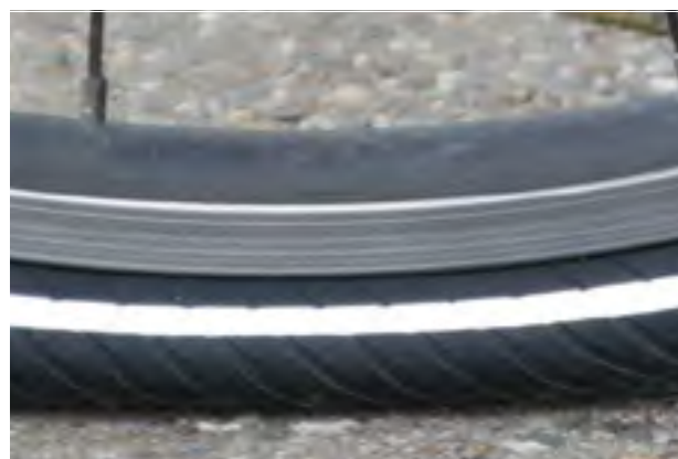
87. ábra: Túlontúl alacsony töltőnyomás
