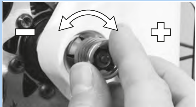
63. ábra: A feszítés beállítása
