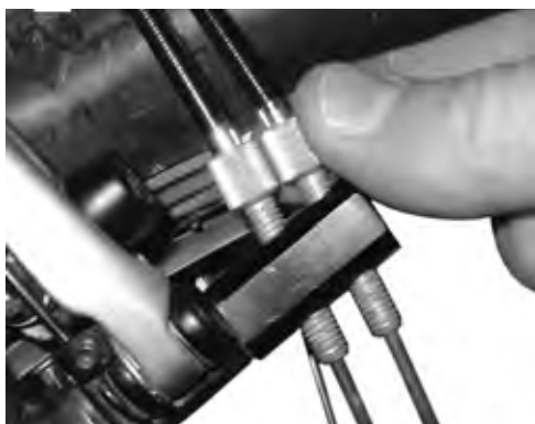
132. ábra: Belső váltóvezérléssel rendelkező Rohloff agyváltozatok húzásbeállítója a húzásellentartón van
