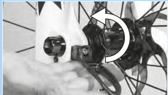
58. ábra: A gyorsár nyomása nyírányban
