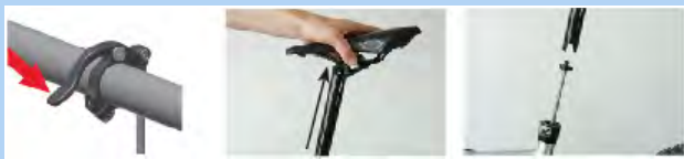
141. ábra: A nyeregcső kihúzása
