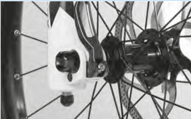
59. ábra: A gyorskioldó kar tökéletes helyzete
