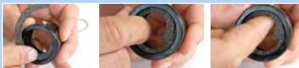
188. ábra: Filcgyűrű behelyezése
