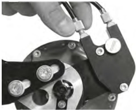
133. ábra: Külső váltóvezérléssel rendelkező Rohloff agyváltozatok húzásbeállítója a kötéldobozon van, ami a bal oldalon található
