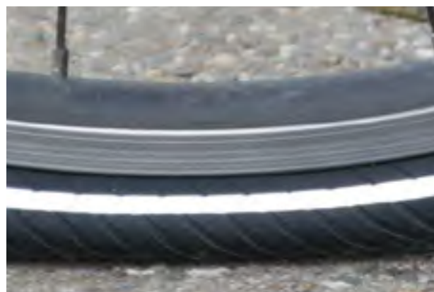
93. ábra: Túlontúl alacsony töltőnyomás
