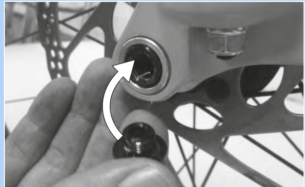
53. ábra: A gyorskioldó kar betolása a tengelybe
