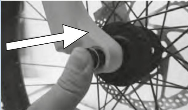
51. ábra: A tengely betolása nyílrányban
