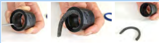
186. ábra: A filcgyűrű eltávolítása
