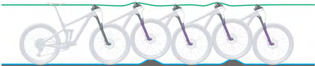
97. ábra: A villa optimális menetviselkedése
