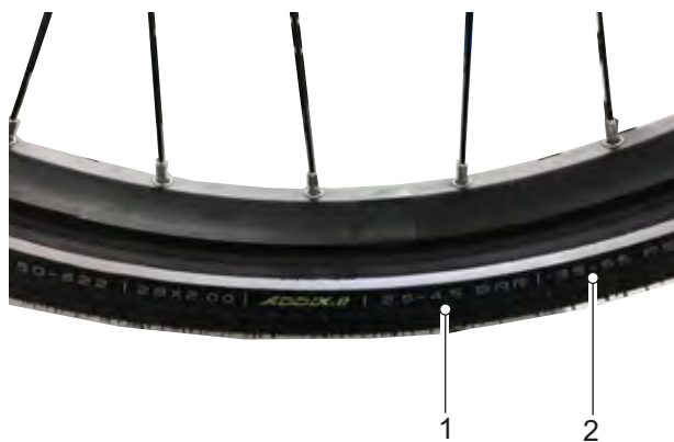
126. ábra: Guminyomás bar-ban (1) és psi-ben (2)
