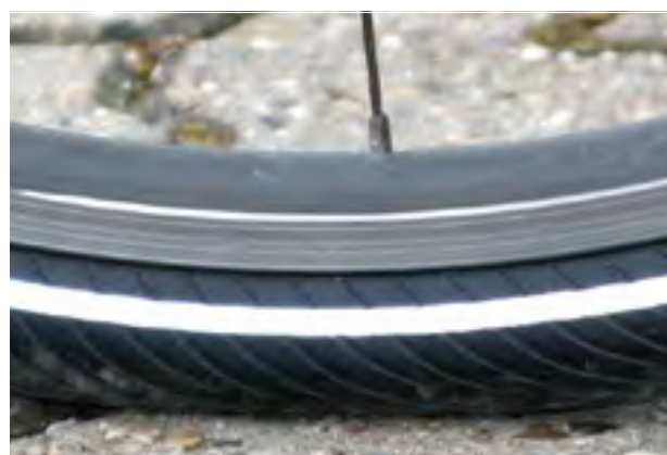
86. ábra: Helyes töltőnyomás. A gumiabroncs alakja a testsúly terhe alatt alig változik
