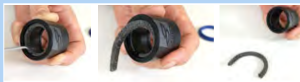
151. ábra: A filcgyűrű eltávolítása
