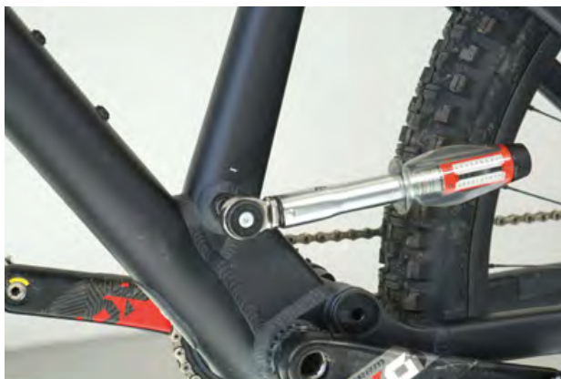
70. ábra: A nyeregcsőtengely meghúzása
