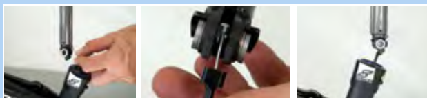
198. ábra: A nyeregcső felakasztása és betolása
