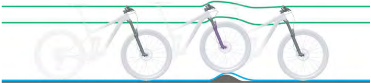
208. ábra: A teleszkópos villa túl kemény csillapítása egyenetlenségeknél
