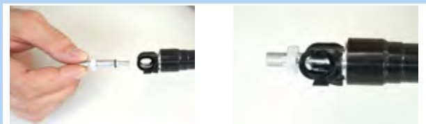
157. ábra: Szelepadapter becsavarozása
