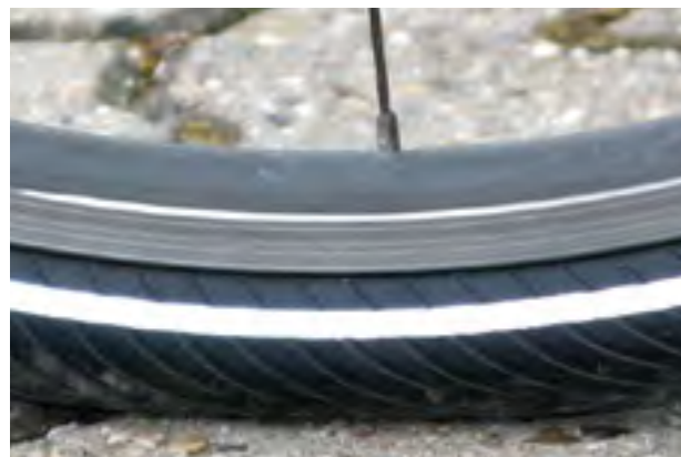
92. ábra: Helyes töltőnyomás. A gumiabroncs alakja a testsúly terhe alatt alig változik
