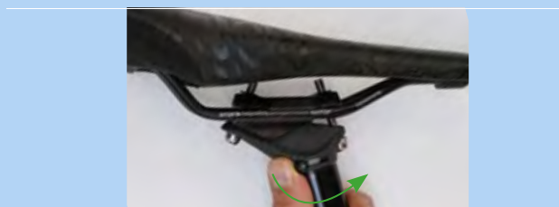
191. ábra: Magasságállítás nyitása
