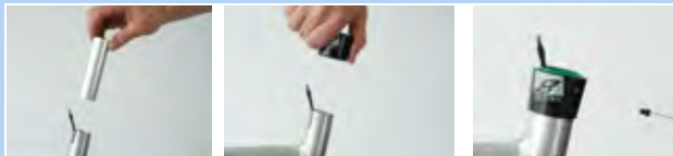
197. ábra: Siklóperselyy és külső hüvely beépítése
