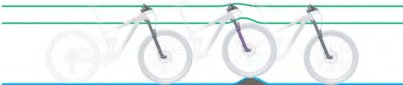
10. ábra: A villa optimális menetviselkedése egyenetlenségek esetén
