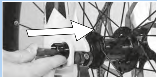
57. ábra: Piros kar betolása nyírányban
