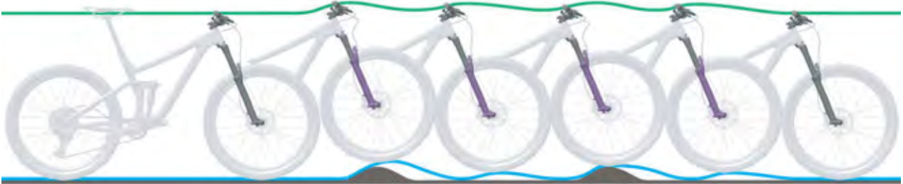
202. ábra: A teleszkópos villa túl gyors kirugózása
