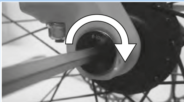
52. ábra: A tengely meghúzása nyílrányban
