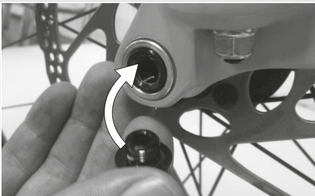
Illustration 13 : Enfoncer le levier d'attache rapide dans l'axe
