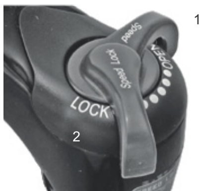
Illustration 49 : Dispositif de réglage de la compression Suntour avec les positions OPEN (1) et LOCK (2)
