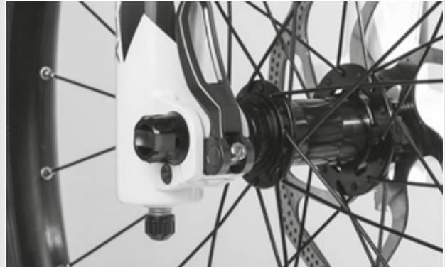
Illustration 54 : Régler la force de serrage de l'attache rapide
