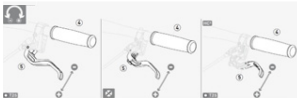
Illustration 41 : Régler la garde d'un levier de frein à disque Magura
