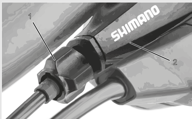
Obr. 86: Seřizovací pouzdro (1) řazení převodů ovládané jedním lankem s řadicí páčkou (2) - příklad
