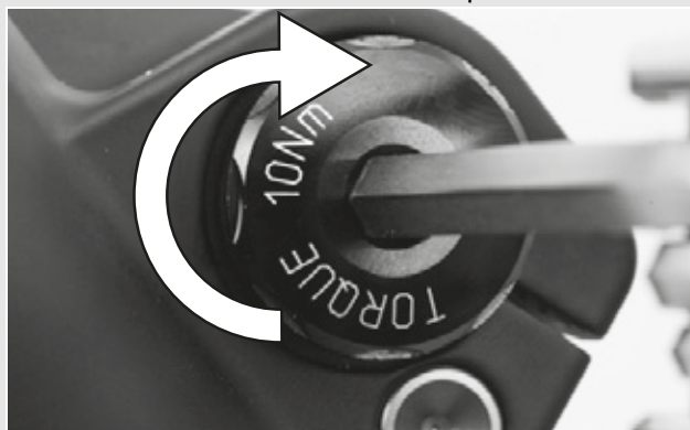
Obr. 29: Utažení zasunuté osy
