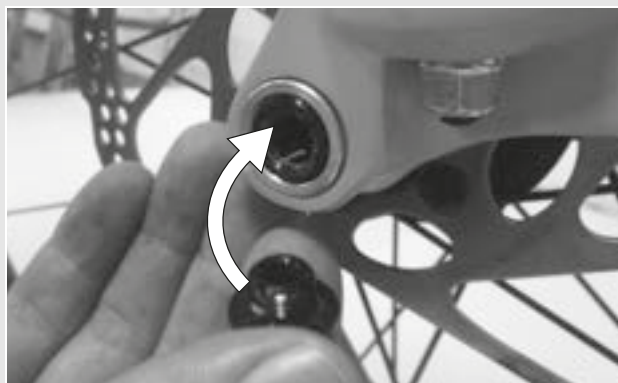
Obr. 27: Zasuňte páku rychloupínáku do osy
