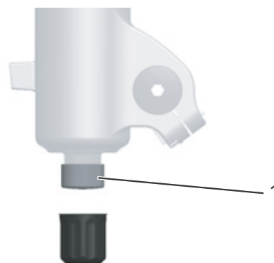
Obr. 60: Nastavovací šroub odskoku FOX na vidlici (1)
