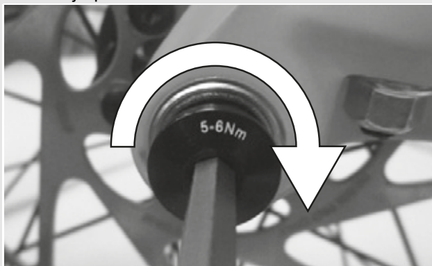
Obr. 28: Utažení pojistného šroubu
