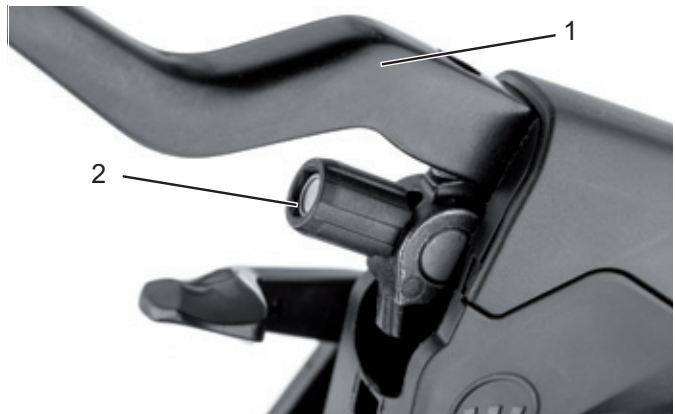
Afbeelding 55: Remhendel (1) van de hydraulisch bediende velgrem met afstelschroef (2)
