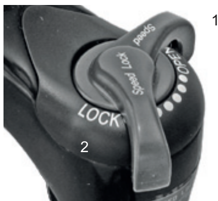
Afbeelding 46: Suntour-drukdemperafsteller met de standen OPEN (1) en LOCK (2)
