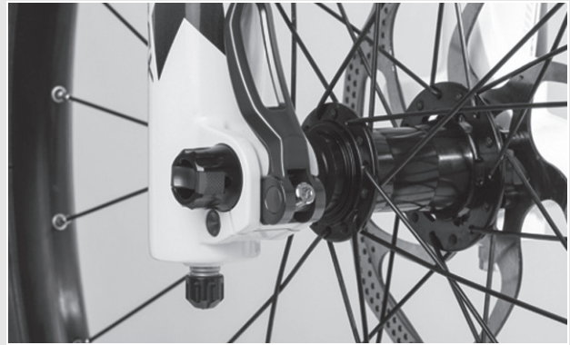
Abbildung 60: Spannkraft des Schnellspanners einstellen
