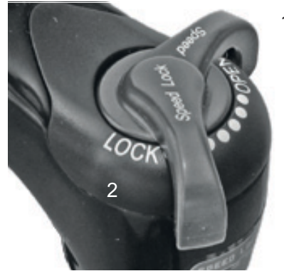
Abbildung 49: Suntour-Druckstufen-Einsteller mit den Positionen OPEN (1) und LOCK (2)
