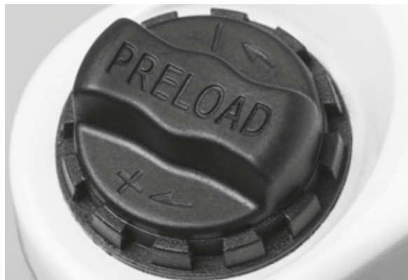
Illustration 57 : Molette de réglage de la course de suspension négative sur la couronne de la fourche de suspension
