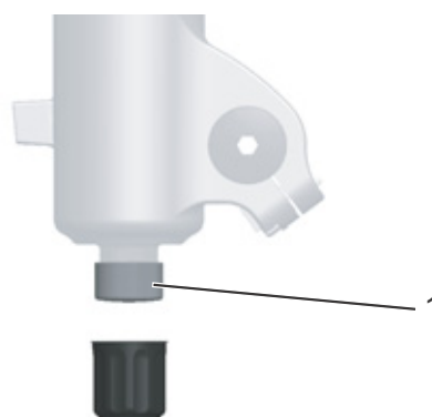
Illustration 59 : Dispositif de réglage de la détente FOX (1) sur la fourche
