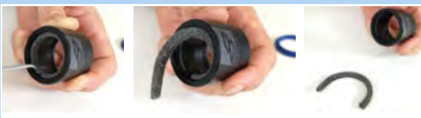
Figura 188: Rimozione dell'anello di feltro
