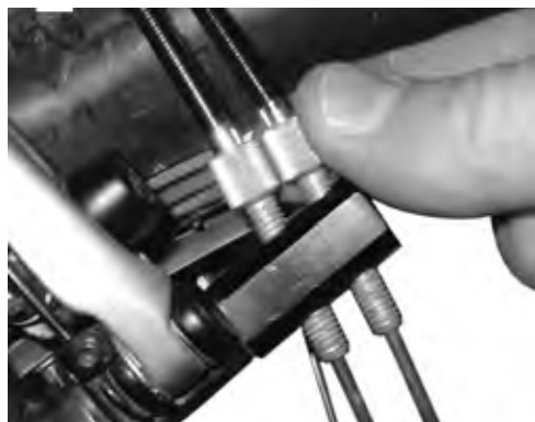
Figura 134: Le versioni del mozzo Rohloff con comando interno del cambio hanno i regolatori del tensionamento sul controsupporto di tensionamento
