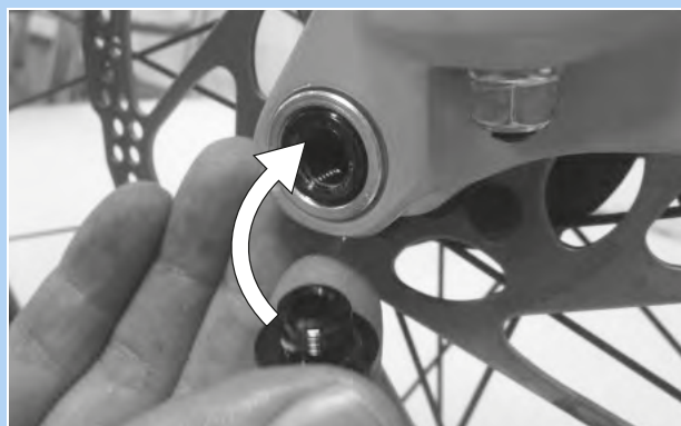
Figura 53: Applicazione della leva del bloccaggio rapido nel perno
