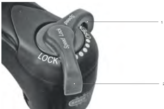
Figura 211: Regolazione più morbida del regolatore dello stadio di compressione
