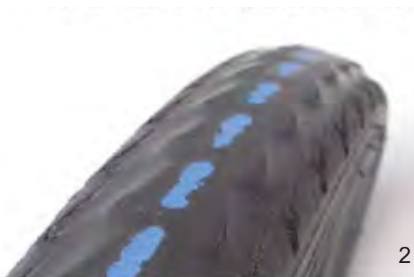
Figura 129: Pneumatico senza profilo ancora utilizzabile (1) e pneumatico con protezione contro le forature in vista (2) che deve essere sostituito
