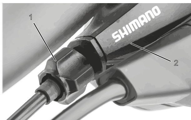
Figura 136: Boccola di regolazione (1) del cambio azionato da cavo singolo con scatola della leva del cambio (2), esempio
