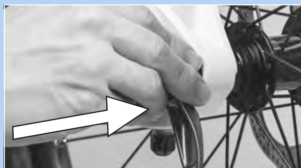
Figura 62: Inserimento del bloccaggio rapido nel verso della freccia
