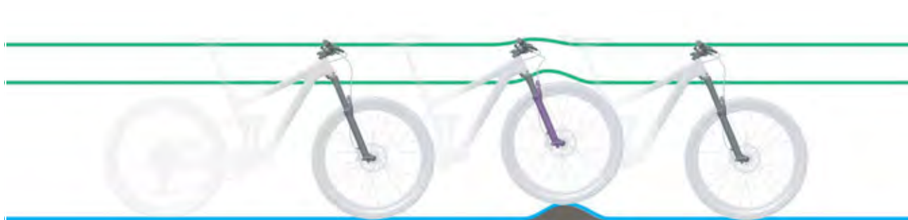
Figura 10: Comportamento di marcia ottimale della forcella su un terreno con asperità
