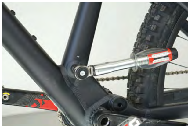
Figura 70: Serraggio dell'asse del canotto reggisella
