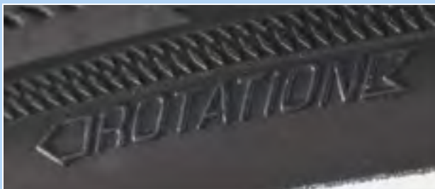
Figura 49: Freccia del senso di rotazione
