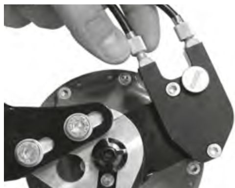
Figura 135: Le versioni del mozzo Rohloff con comando esterno del cambio hanno i regolatori del tensionamento sulla scatola dei cavi situata sul lato sinistro
