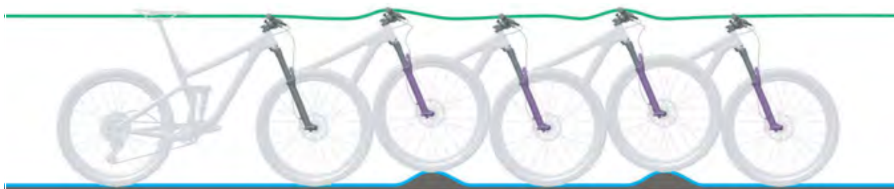
Figura 97: Comportamento di marcia ottimale della forcella
