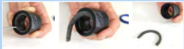
Figura 153: Rimozione dell'anello di feltro
