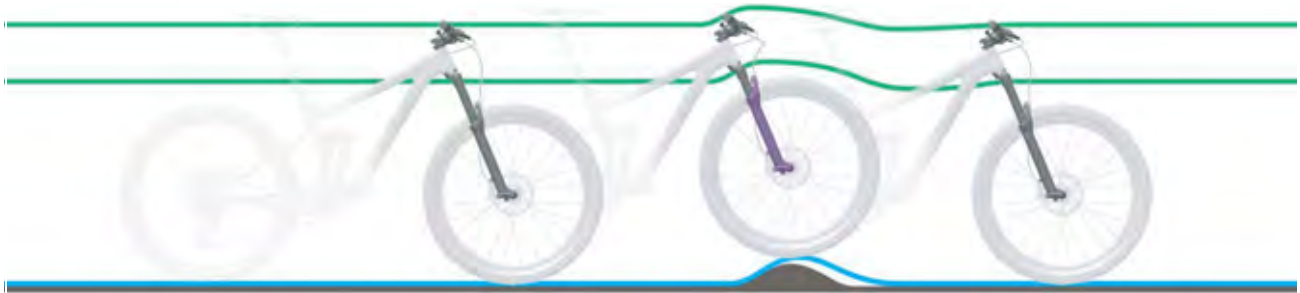
Figura 210: Smorzamento troppo duro della forcella ammortizzata su asperità
