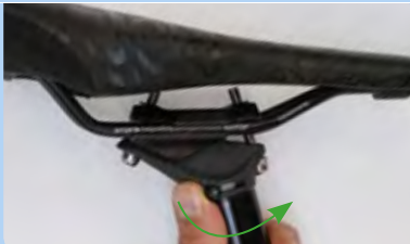
Figura 193: Apertura della regolazione in altezza
