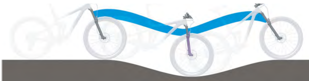
Figura 9: Comportamento di marcia ottimale della forcella su un terreno con dossi
