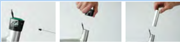
Figura 150: Smontaggio della boccola esterna e del manicotto scorrevole
