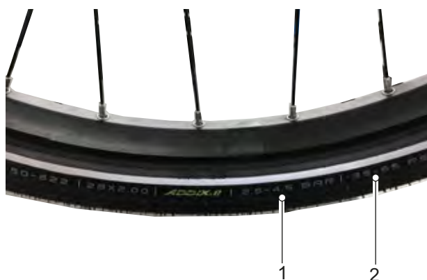
Figura 128: Pressione di gonfiaggio in bar (1) e in psi (2)
