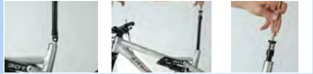
Figura 170: Fissaggio del coperchio della valvola della cartuccia
