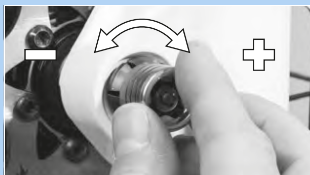
Figura 63: Regolazione del serraggio
