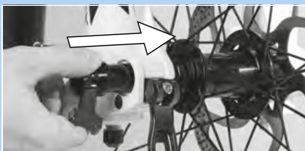
Figura 55: Inserimento del perno passante nel verso della freccia
