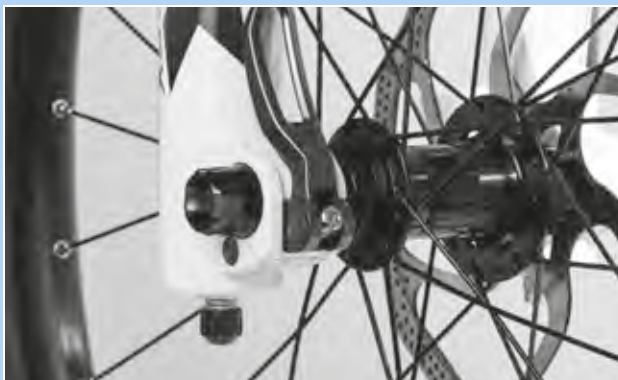
Figura 139: Regolazione della forza di serraggio del bloccaggio rapido
