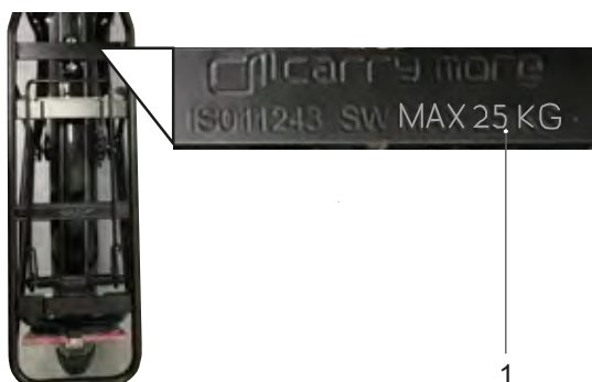
Figura 107: Sul portapacchi è indicata la sua portata massima (1).
