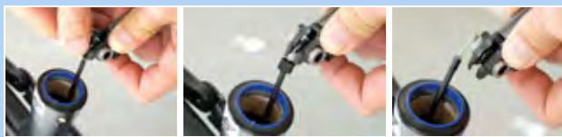
Figura 183: Rimozione del cavo meccanico
