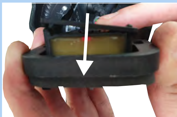
Figura 48: Fissaggio della clip
