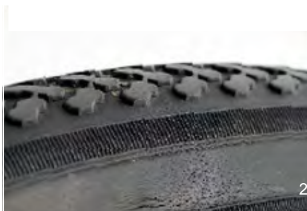
Figura 130: Esempi di crepe da fatica (1) e da invecchiamento (2)
