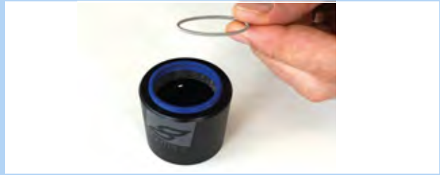
Figura 151: Anello elastico smontato
