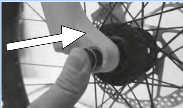
Figura 51: Insetimento del perno nel verso della freccia
