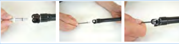
Figura 161: Fissaggio del coperchio della valvola della cartuccia
