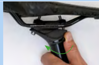
Figura 198: Chiusura della regolazione in altezza
