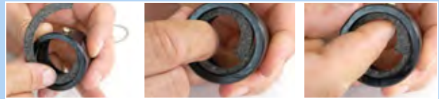
Figura 190: Applicazione dell'anello di feltro
