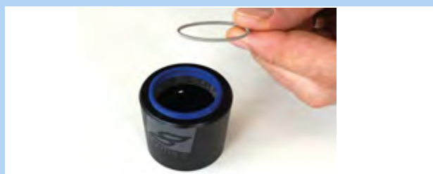
Figura 186: Anello elastico smontato
