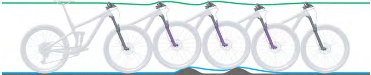
Figura 206: Corsa di estensione troppo lenta della forcella ammortizzata
