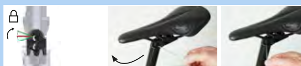
Figura 179: Chiusura della regolazione in altezza
