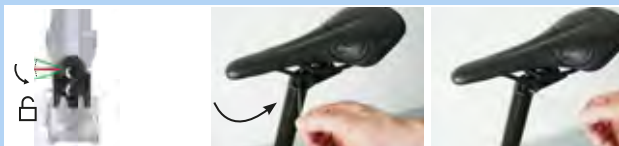
Figura 142: Posizionamento dell'azionamento della regolazione in altezza in posizione orizzontale
