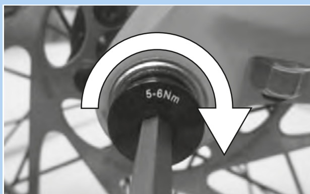
Figura 54: Serraggio della vite di sicurezza
