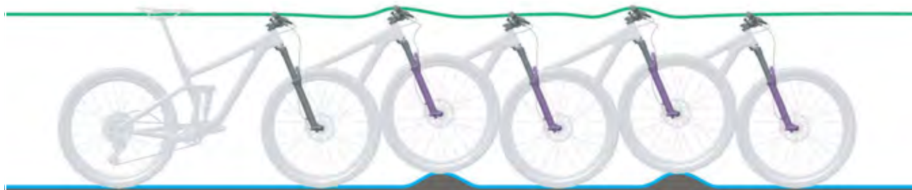
Figura 11: Comportamento di marcia ottimale della forcella
