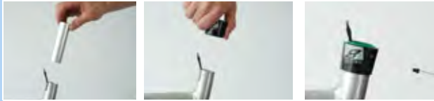
Figura 166: Montaggio del manicotto scorrevole e della boccola esterna
