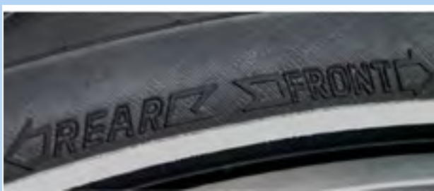
Figura 50: Freccia del senso di rotazione su pneumatici MTB
