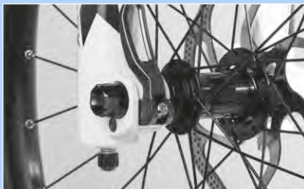
Figura 59: Corretta posizione della leva di serraggio
