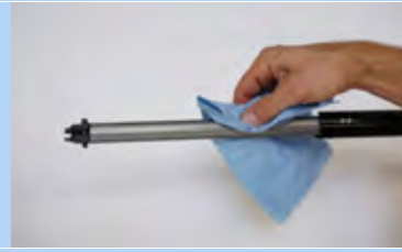
Figura 195: Pulizia della scanalatura di guida longitudinale
