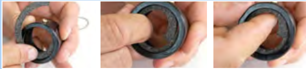
Figura 155: Applicazione dell'anello di feltro
