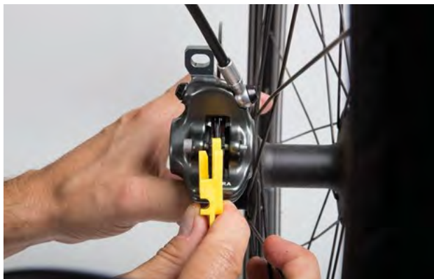
Figura 131: Controllo della guarnizione del freno nello stato montato mediante la sicura di trasporto
