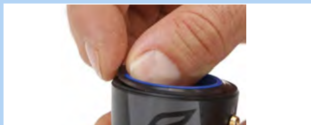
Figura 185: Estrazione dell'anello a labbro di tenuta
