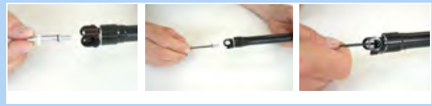
Figura 165: Fissaggio del coperchio della valvola della cartuccia
