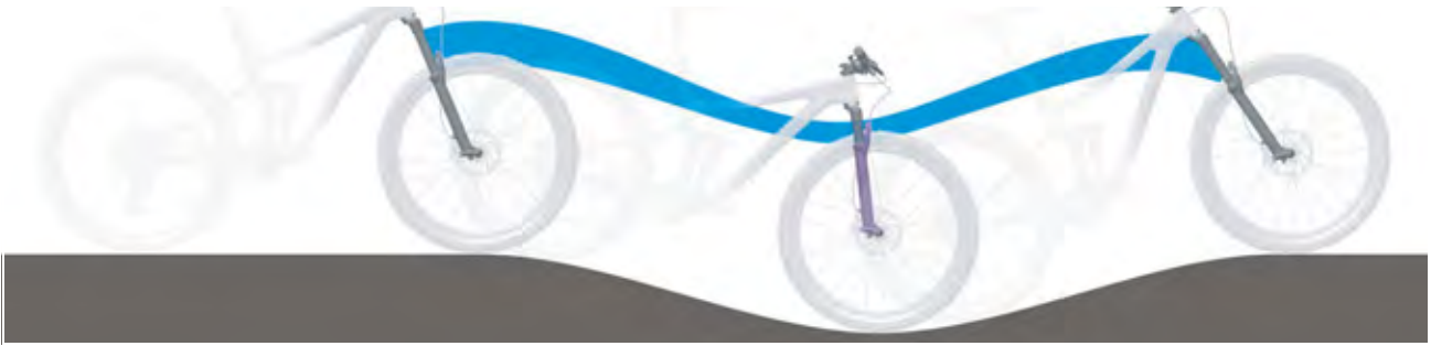
Figura 208: Sospensione della forcella ammortizzata troppo morbida in salita
