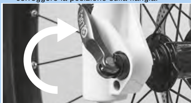
Figura 64: Chiusura del bloccaggio rapido
