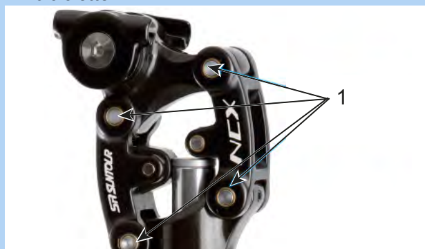
Figura 141: Punti di lubrificazione del cannotto reggisella ammortizzato SR Suntour
