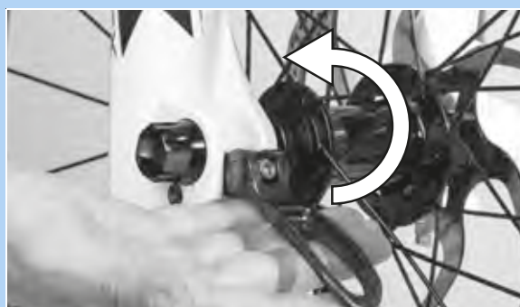
Figura 58: Spinta della leva del bloccaggio rapido nel verso della freccia
