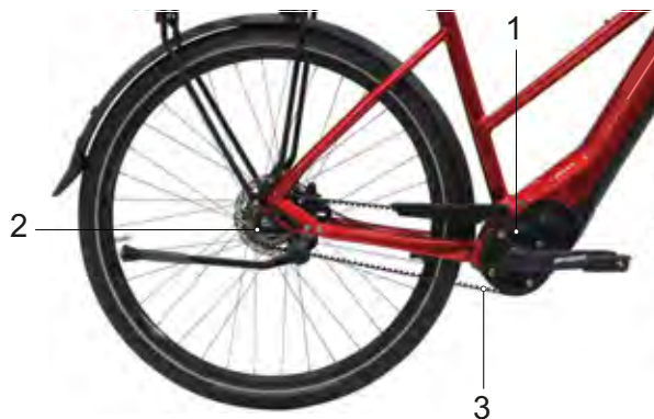
Figura 28: Schema della trasmissione a cinghia
