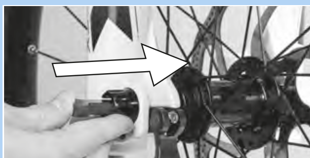
Figura 57: Inserimento della leva rossa nel verso della freccia
