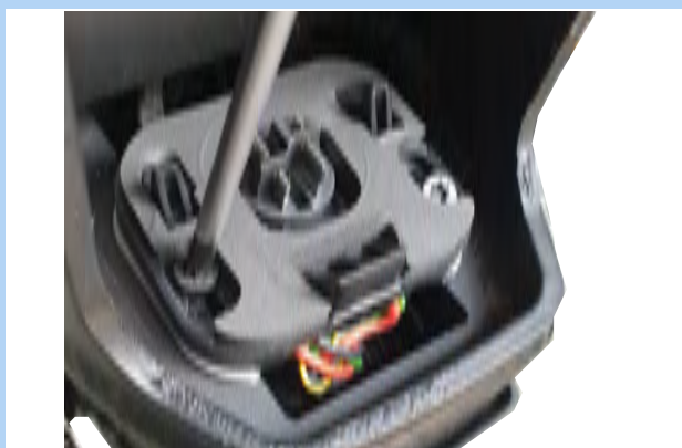
Figura 46: Svitamento delle viti del portabatteria
