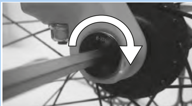
Figura 52: Serraggio del perno nel verso della freccia
