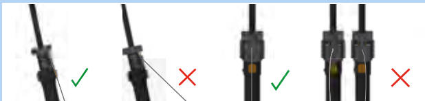
Figura 169: Cavo meccanico corretto ed errato
