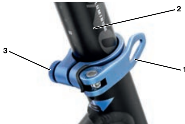
Abbildung 14: Schnellspanner der Sattelstütze in der Endposition
