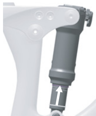
Afbeelding 60: O-ring op de achterbouwdemper verschuiven
