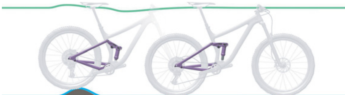
Afbeelding 12: Optimaal rijgedrag van de achterbouwdeemper bij oneffenheden
