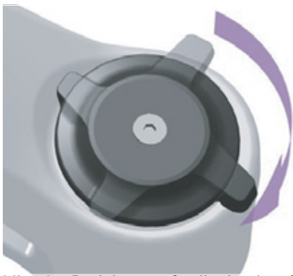
Afbeelding 94: Drukdemperafsteller harder afstellen
