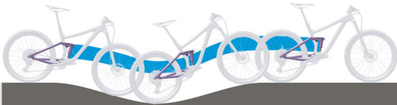
Afbeelding 68: Optimaal rijgedrag van de achterbouwdemper in heuvelachtig terrein
