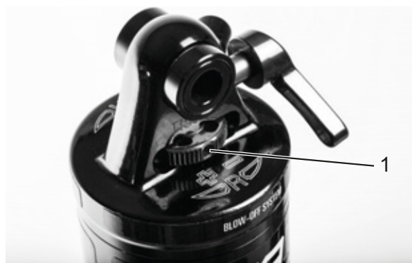
Afbeelding 64: Wiel (1) van de Suntour trekdemperafsteller op de achterbouwdemper
