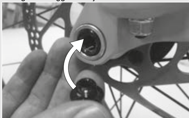
Afbeelding 24: Snelspanhendel in as schuiven
