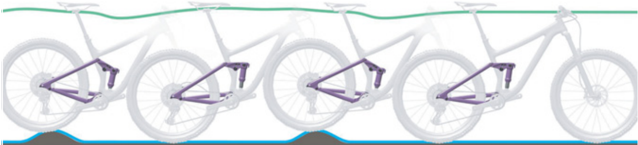
Afbeelding 10: Optimaal rijgedrag van de achterbouwdeemper
