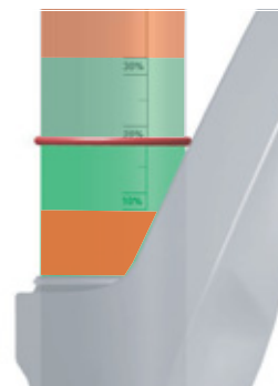
Afbeelding 58: Voorgeschreven sagbereik (groen) en verboden sagbereik
