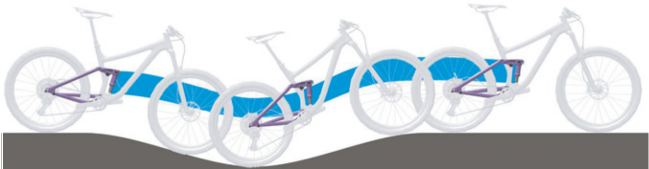
Afbeelding 11: Optimaal rijgedrag van de achterbouwdeemper in heuvelachtig terrein
