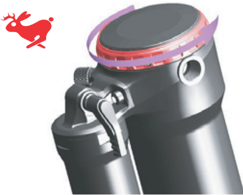
Afbeelding 100: Draai de trekdemperafsteller in de richting van de haas
