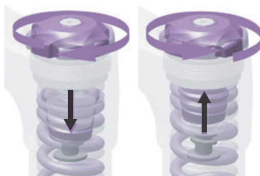
Afbeelding 55: Voorspanningsafstelling in- en uitdraaien
