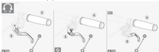
Afbeelding 51: Grijpafstand Magura schijfremhendel afstellen
