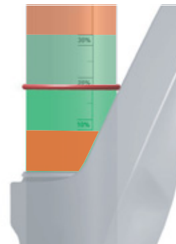
Rysunek 58: Zalecany zakres parametru SAG (zielony) i zakazany zakres parametru AG
