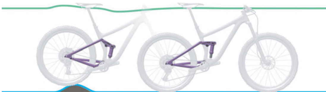
Rysunek 12: Optymalne działanie tylnego amortyzatora na nierównościach
