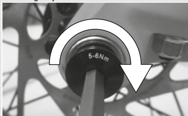
Rysunek 25: Sposób dokręcania śruby zabezpieczającej
