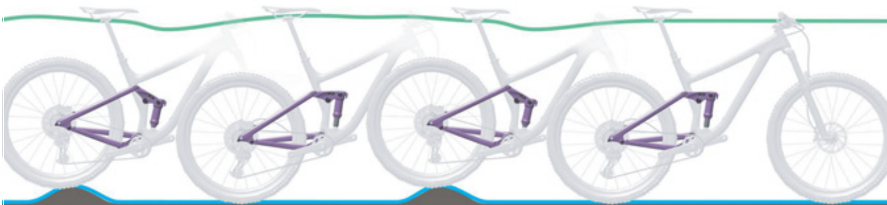
Rysunek 62: Optymalne działanie tylnego amortyzatora
