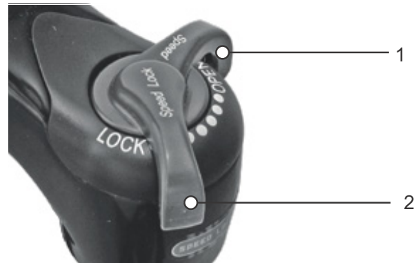
Rysunek 77: Tłumik dobicia Suntour w otwartej (1) i zamkniętej (2) pozycji
