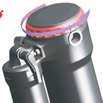
Rysunek 100: Obrócić pokrętko amortyzatora odbicia w kierunku symbolu zająca
