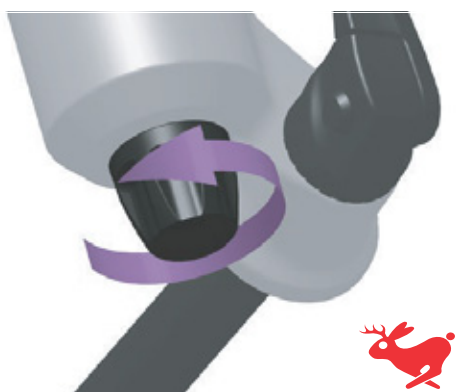
Rysunek 92: Obrócić pokrętko amortyzatora odbicia w kierunku symbolu zająca
