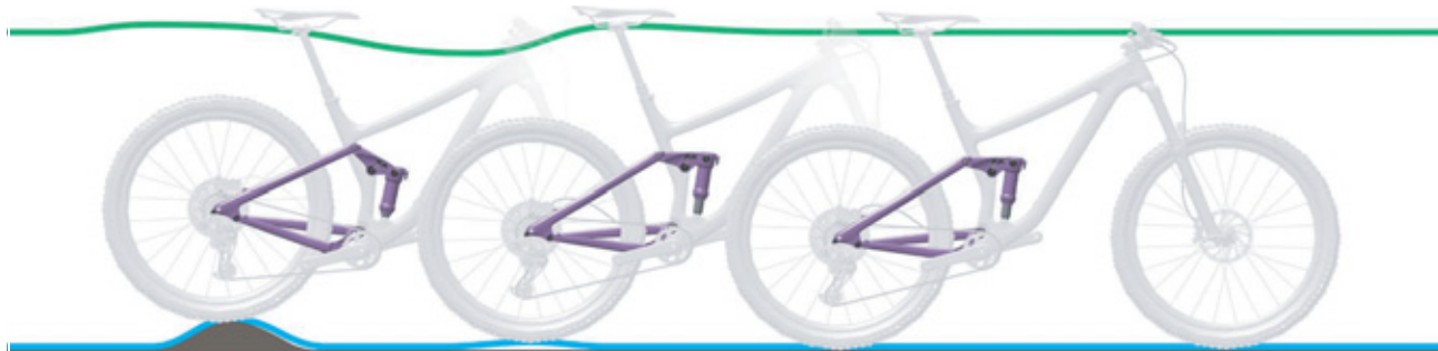
Rysunek 97: Zbyt szybkie rozprężanie się tylnego amortyzatora
