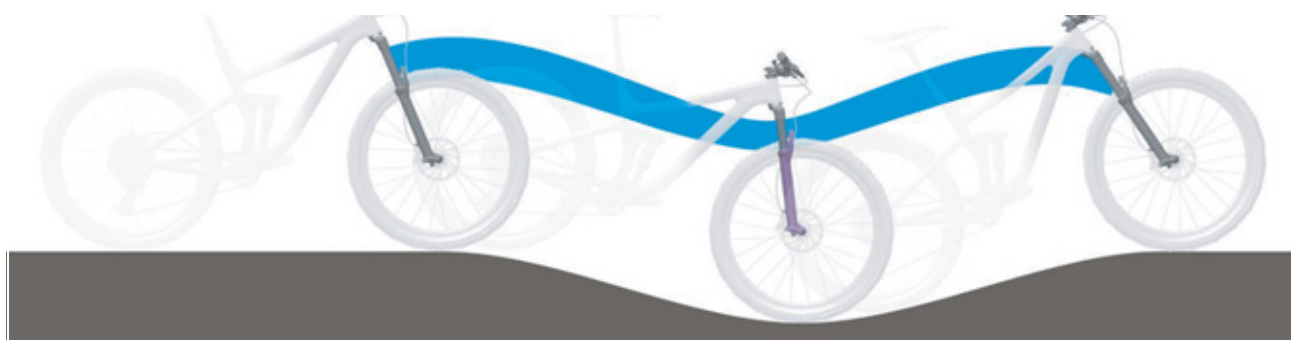
Rysunek 6: Optymalne działanie widełca na pagórkowatym terenie
