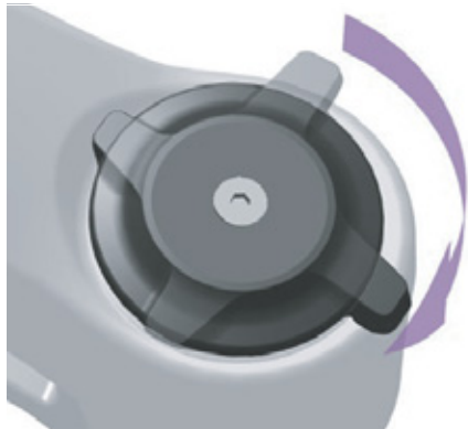
Rysunek 78: Ustawienie nastawnika dobiecia na twardszy tryb pracy
