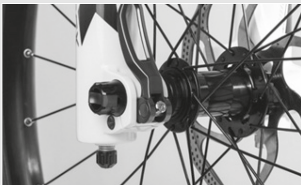
Rysunek 32: Optymalne położenie dźwigni mocującej
