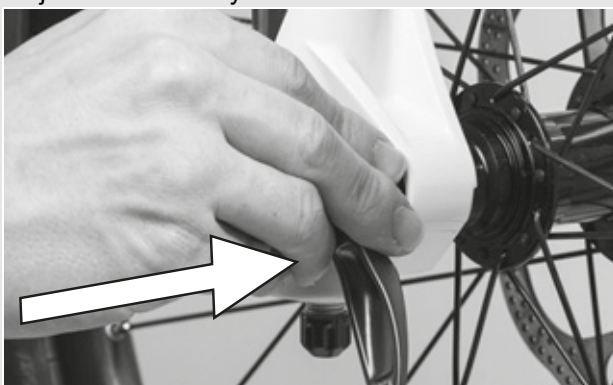
Rysunek 35: Wsuwanie zacisku szybko mocującego
