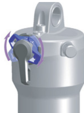
Rysunek 71: Ustawienie nastawnika dobicia na twardszy tryb pracy
