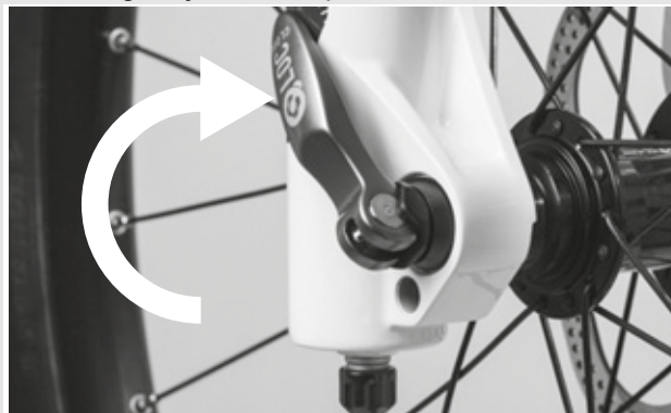
Rysunek 37: Zamykanie zacisku szybko mocującego
