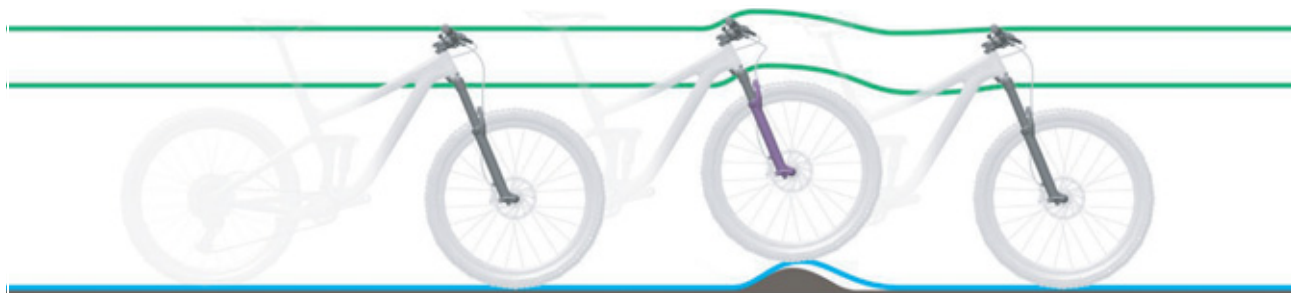
Rysunek 95: Zbyt twarde tłumienie widełca amortyzowanego na nierównościach
