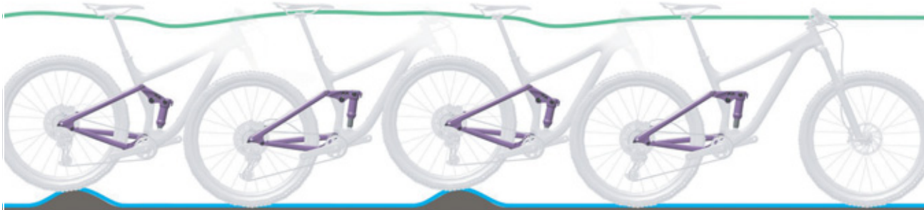
Rysunek 10: Optymalne działanie tylnego amortyzatora
