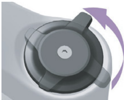
Rysunek 79: Ustawienie nastawnika dobiecia na bardziej miękki tryb pracy
