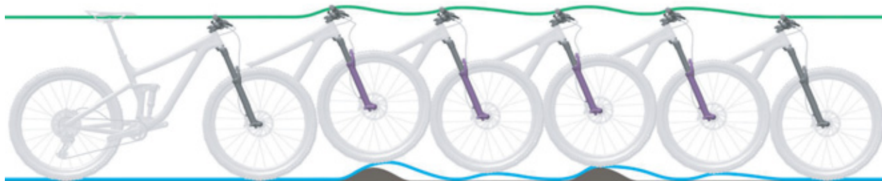
Rysunek 89: Zbyt szybkie rozprężanie widelca amortyzowanego
