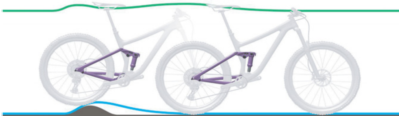
Rysunek 103: Zbyt twarde tłumienie tylnego amortyzatora na nierównościach
