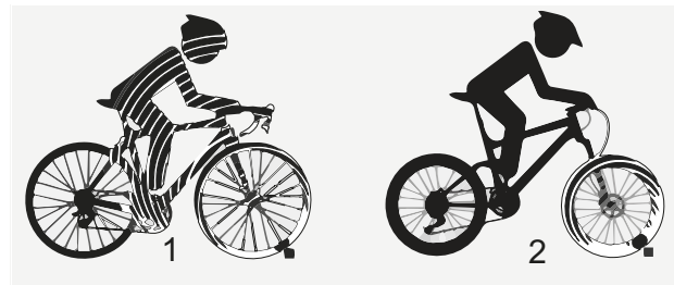
Rysunek 4: Rower typu Pedelec niewyposażony (1) i wyposażony (2) w układ amortyzacji
