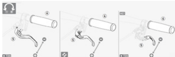
Rysunek 49: Ustawianie odchylenia manetki dźwigni hamulca tarczowego Magura
