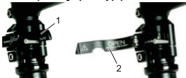
Rysunek 47: Zamknięta (1) i otwarta (2) dźwignia mocująca mostek; przykład – system regulacji wysokości kierownicy speedlifter firmy by.schulz
