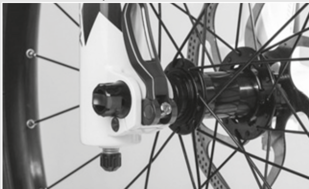
Rysunek 67: Ustawianie siły mocowania zacisku szybkomocującego
