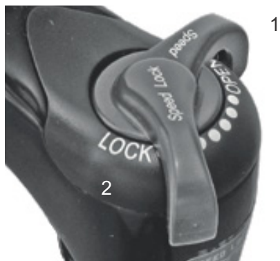
Rysunek 63: Nastawnik dobicia Suntour z pozycjami OPEN (1) i LOCK (2)
