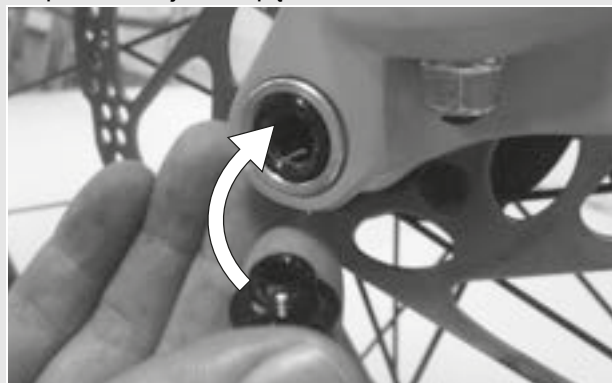
Rysunek 23: Sposób wsuwania dźwigni zacisku szybkocmocującego w oś
