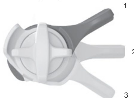
Afbeelding 65: FOX-drukdemperafsteller op de achterbouwdemper met de standen OPEN (1), MIDDEL (2) en HARD (3)
