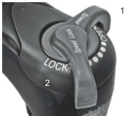
Afbeelding 67: Suntour-drukdemperafsteller met de standen OPEN (1) en LOCK (2)
