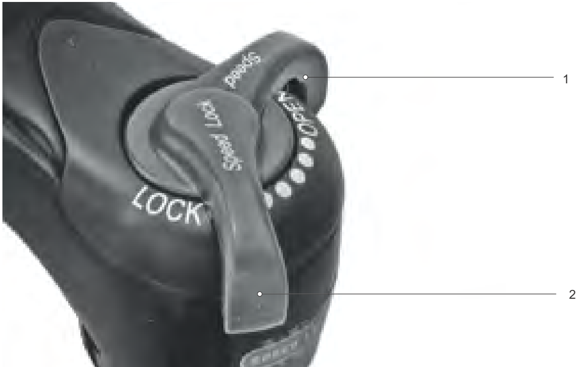
Afbeelding 119: Suntour drukdemper in open (1) en gesloten (2) stand
