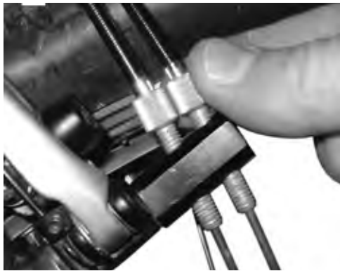
Afbeelding 132: Bij Rohloff naafversies met interne schakelaansturing zit de kabelafsteller op de tegenhouder van de kabel.
