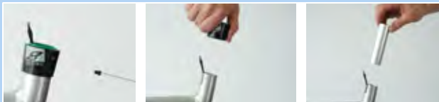
Afbeelding 148: Buithuls en glijbus demonteren
