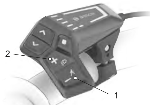
Afbeelding 116: Locatie plus-toets en min-toets
