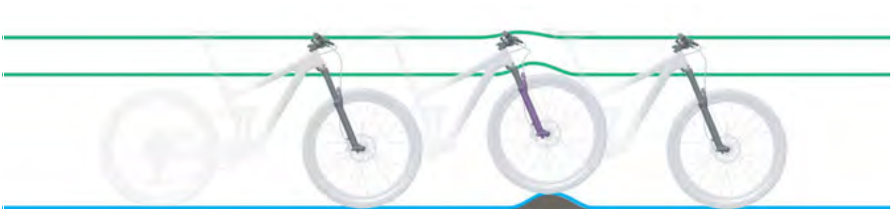
Afbeelding 10: Optimaal rijgedrag van de vork bij oneffenheden
