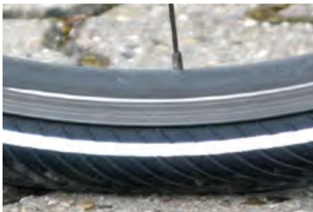
Afbeelding 92: Juiste vuldruk. De band is onder de belasting van het lichaamsgewicht nauwelijks vervormd
