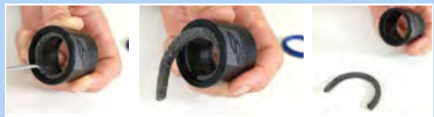
Afbeelding 151: Viltten ring verwijderen
