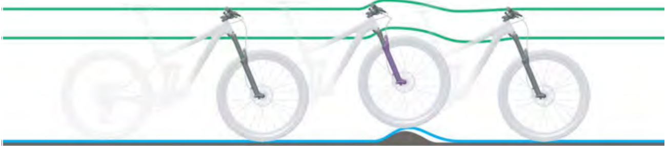
Afbeelding 208: Te harde demping de verende voorvork bij oneffenheden
