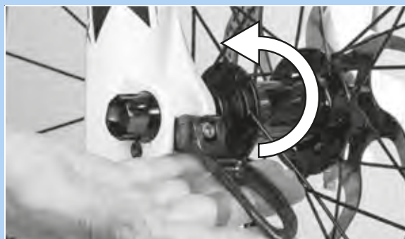
Afbeelding 58: Snelspanhendel in de richting van de pijl drukken
