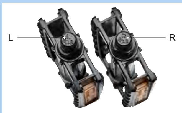
Afbeelding 65: Voorbeeld markering op pedalen
