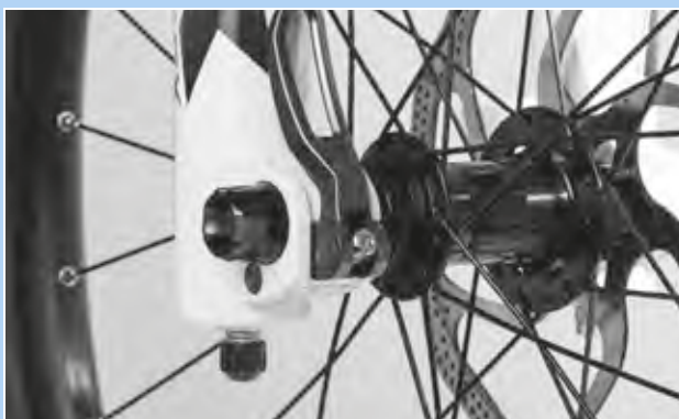
Afbeelding 137: Spankracht van de snelspanner afstellen
