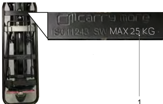
Afbeelding 107: Op de bagagedrager staat het maximale draagvermogen (1) vermeld
