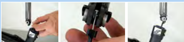
Afbeelding 198: Zadelpen ophangen en inschuiven
