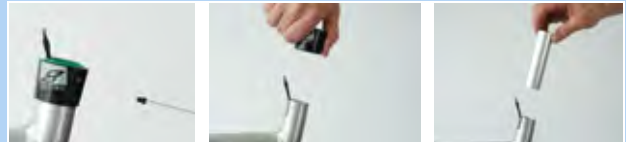
Afbeelding 182: Buitenhuls en glijbus demonteren
