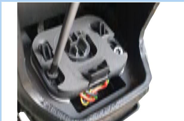
Afbeelding 46: Schroeven accuhouder losdraaien
