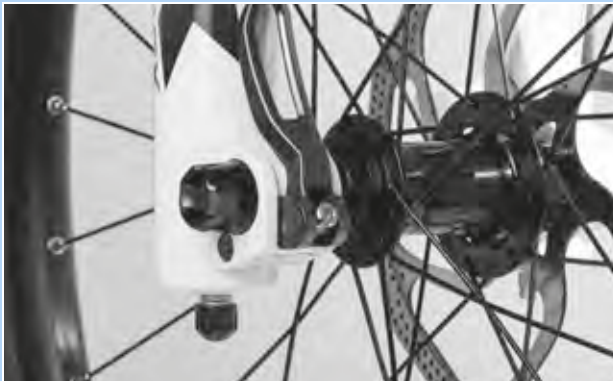
Afbeelding 59: Perfecte stand van de spanhendel
