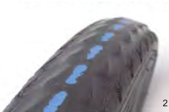
Afbeelding 127: Een band zonder profiel waarmee nog kan worden gereden (1), en een band met zichtbare anti-leklaag (2), die moet worden vervangen
