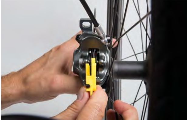
Afbeelding 129: Remvoering in gemonteerde toestand controleren met behulp van de transportbeveiliging
