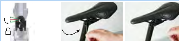
Afbeelding 140: Bediening hoogteverstelling in stand "geopend" zetten
