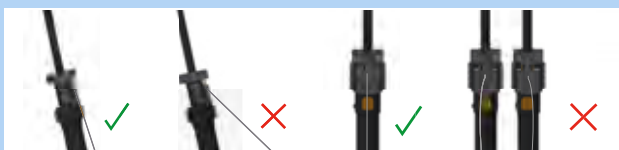
Afbeelding 167: Correcte en verkeerde bowdenkabel
