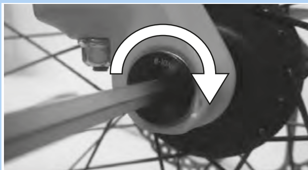
Afbeelding 52: As in de richting van de pijl vastdraaien
