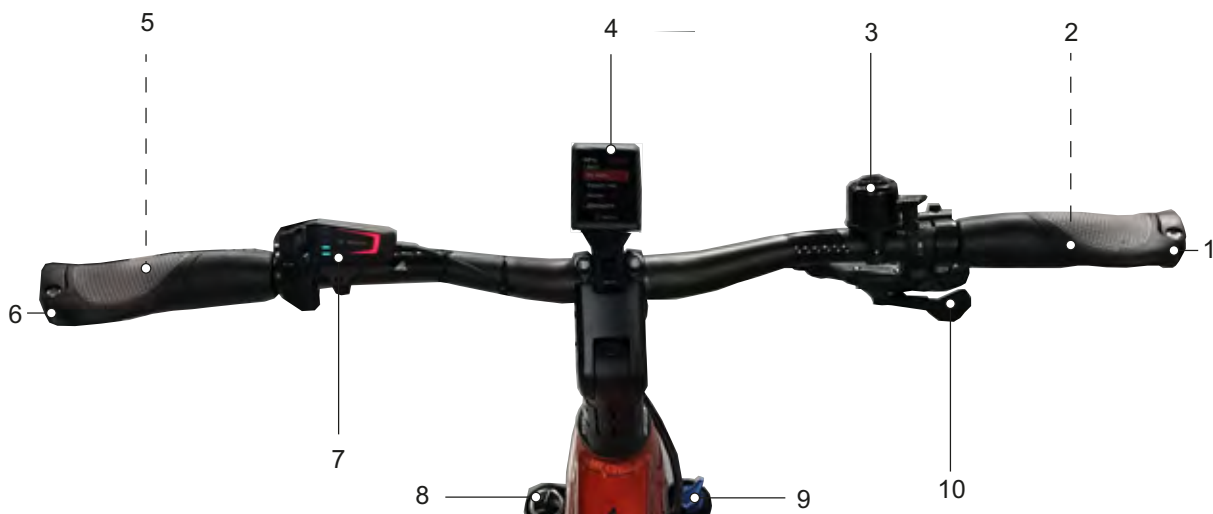
Afbeelding 34: Detailaanzicht stuur met BOSCH Kiox300, voorbeeld
