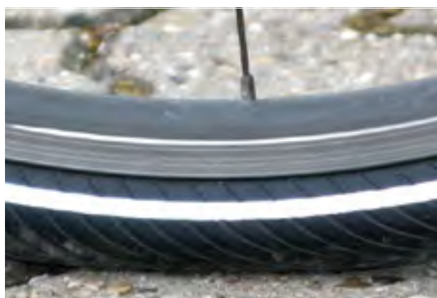
Afbeelding 86: Juiste vuldruk. De band is onder de belasting van het lichaamsgewicht nauwelijks vervormd
