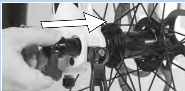
Afbeelding 55: Dwarsas in de richting van de pijl inschuiven
