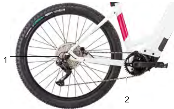
Afbeelding 27: Schema kettingaandrijving met derailleur
