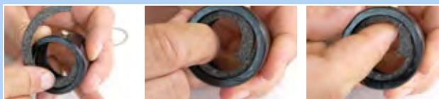
Afbeelding 153: Viltten ring inleggen
