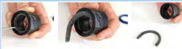
Afbeelding 186: Vilten ring verwijderen
