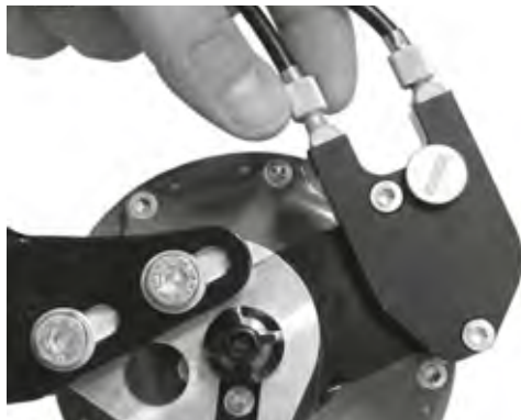
Afbeelding 133: Bij Rohloff naafversies met externe schakelaansturing zit de kabelafsteller op de kabelbox aan de linkerkant.
