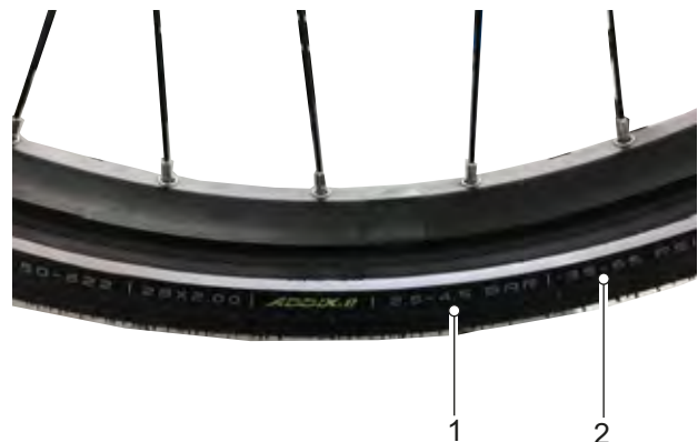
Afbeelding 126: Vuldruk in bar (1) en psi (2)
