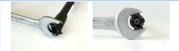
Afbeelding 161: Borgen tegen verdraaien
