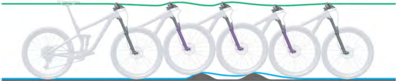
Afbeelding 204: Te langzaam uitveren van de verende voorvork
