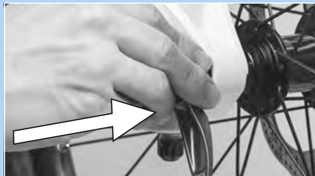
Afbeelding 62: Snelspanner in de richting van de pijl inschuiven
