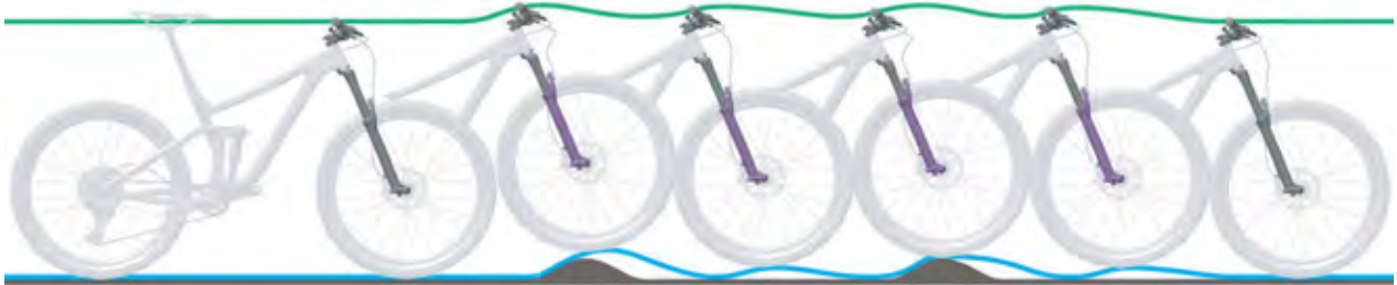
Afbeelding 202: Te snel uitveren van de verende voorvork
