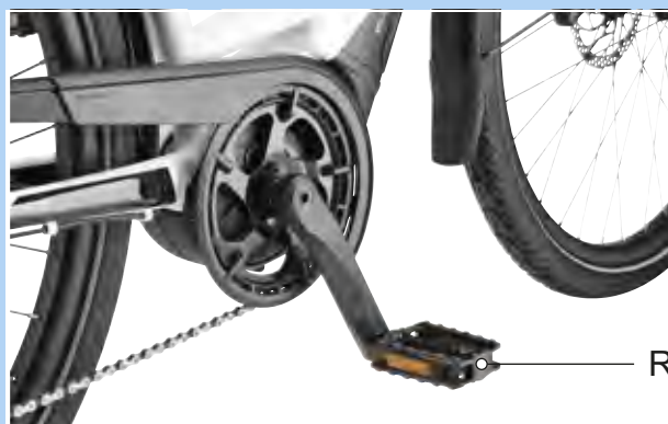
Afbeelding 67: R-pedaal in de rechter crankarm
