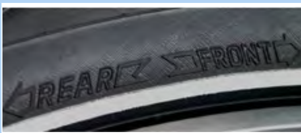
Afbeelding 50: Pijl draairichting op MTB-band
