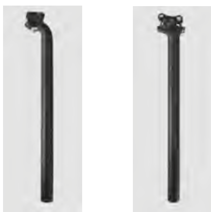
Afbeelding 24: Voorbeeld ergotec patentzadelpen met één of twee zadelklemmschroeven op de kop
