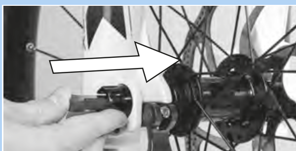
Afbeelding 57: Rode hendel in de richting van de pijl inschuiven
