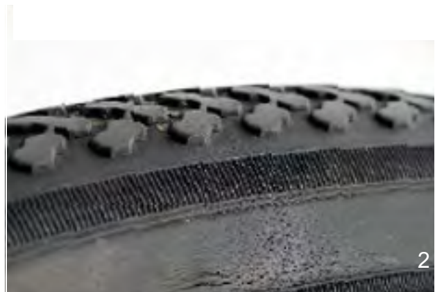
Afbeelding 128: Voorbeelden van vermoeiingsscheuren (1) en verouderingsscheuren (2)
