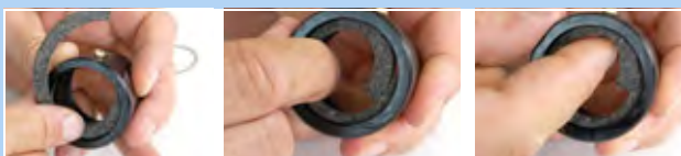
Afbeelding 188: Vilten ring inleggen
