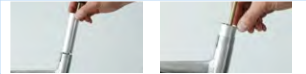
Afbeelding 171: Buis van de glijbus in de zadelbuis schuiven
