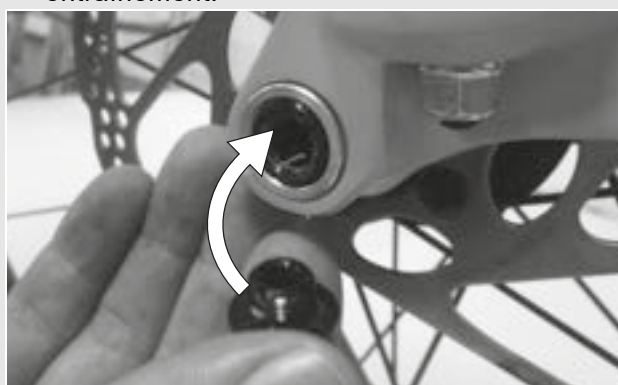
Illustration 24 : Enfoncer le levier d'attache rapide dans l'axe
