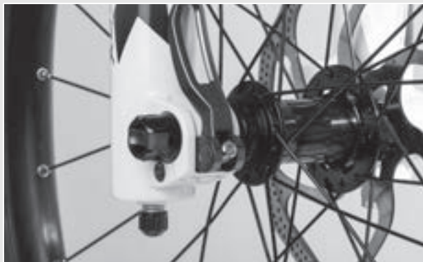
Abbildung 90: Spannkraft des Schnellspanners einstellen
