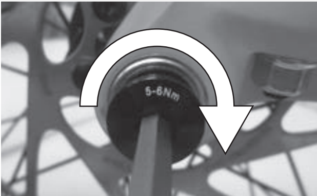
Abbildung 30: Sicherungsschraube anziehen
