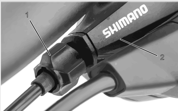
Abbildung 92: Einstellhülse (1) der einzügigen, seilzugbetätigten Gangschaltung mit Schalthebelgehäuse (2), Beispiel
