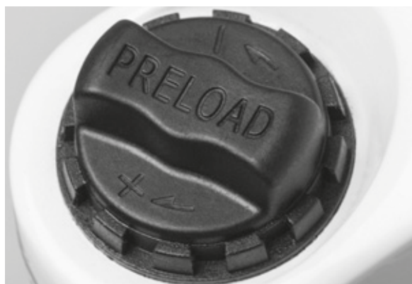
Afbeelding 43: Afstelwiel voor de negatieve veerweg op de kroon van de verende voorvork
