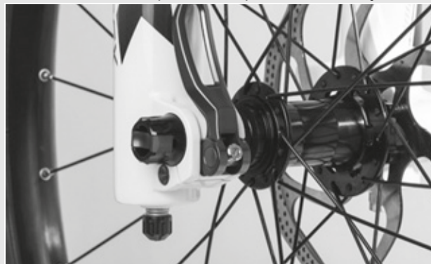
Afbeelding 54: Spankracht van de snelspanner afstellen
