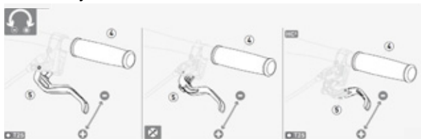
Illustration 51 : Régler la garde d'un levier de frein à disque Magura
