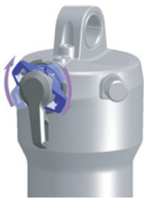
Illustration 102 : Régler le dispositif de réglage de la compression sur un niveau plus dur
