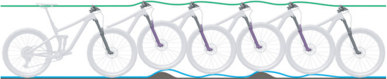
Illustration 89 : Détente trop rapide de la fourche de suspension
