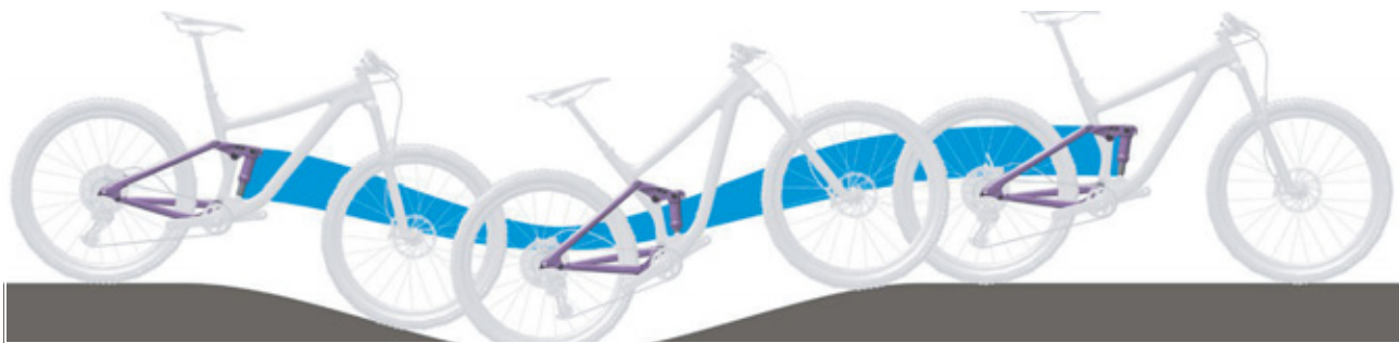
Illustration 101 : Suspension trop souple de l'amortisseur arrière dans les côtes
