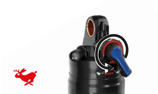
Illustration 67 : Augmenter la vitesse de détente
