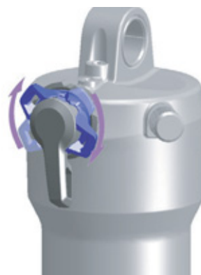
Illustration 71 : Régler le dispositif de réglage de la compression sur un niveau plus dur
