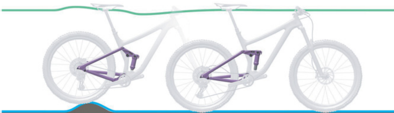
Illustration 69 : Comportement optimal de l'amortisseur arrière sur des irrégularités
