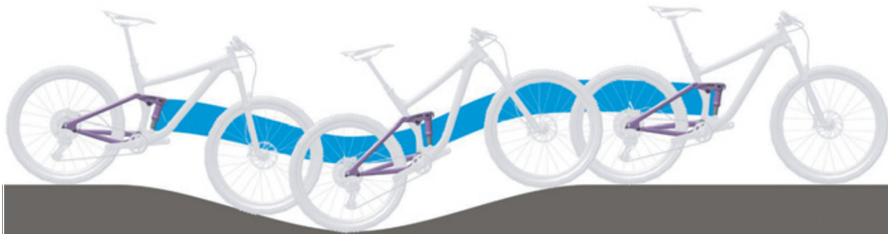
Illustration 68 : Comportement optimal de l'amortisseur arrière en terrain vallonné
