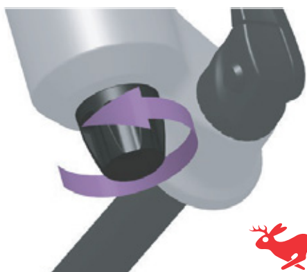
Illustration 92 : Tourner l'amortisseur de détente vers le lièvre
