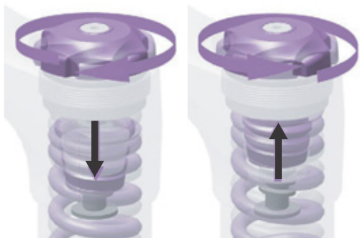
Illustration 55 : Serrer et desserrer l'anneau de réglage de la prétension.
