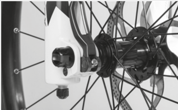
Figura 34: Corretta posizione della leva di serraggio
