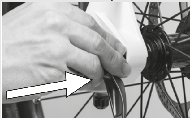
Figura 37: Inserimento del bloccaggio rapido
