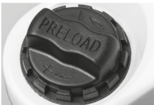
Figura 44: Manopola di regolazione dell'escursione negativa della sospensione sulla corona della forcella ammortizzata
