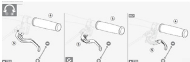
Figura 42: Regolazione dell'ampiezza di presa della leva del freno Magura con freno a disco
