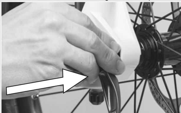
Figura 27: Inserimento del bloccaggio rapido
