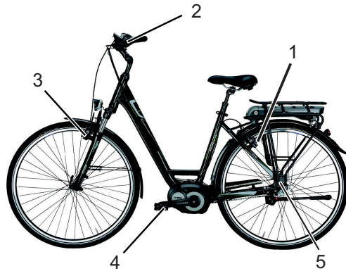
Bremssystem eines Fahrrads mit einer Rücktrittbremse, Beispiel
