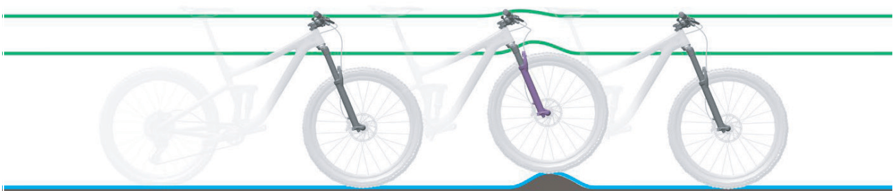
Abbildung 7: Optimales Fahrverhalten der Gabel bei Unebenheiten
