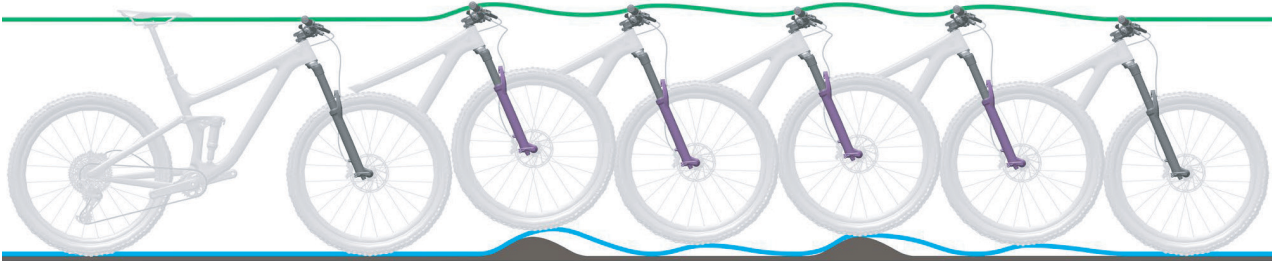
Abbildung 55: Zu schnelles Ausfedern der Federgabel
