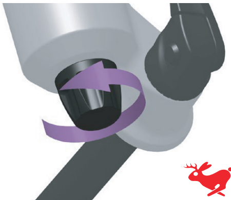
Abbildung 58: Zugstufendämpfer in Richtung Hase drehen
