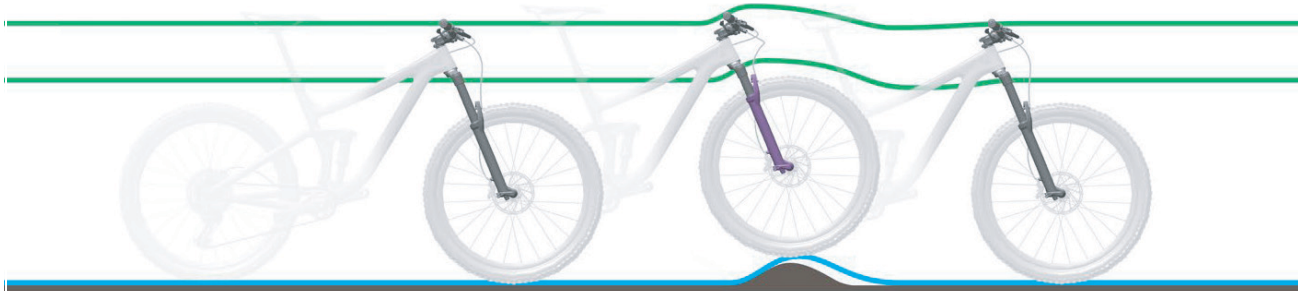
Abbildung 61: Zu harte Dämpfung der Federgabel bei Unebenheiten
