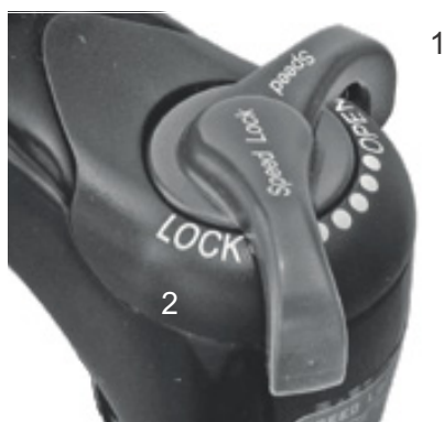
Figura 49: Regolatore dello stadio di pressione Suntour con posizioni OPEN (1) e LOCK (2)
