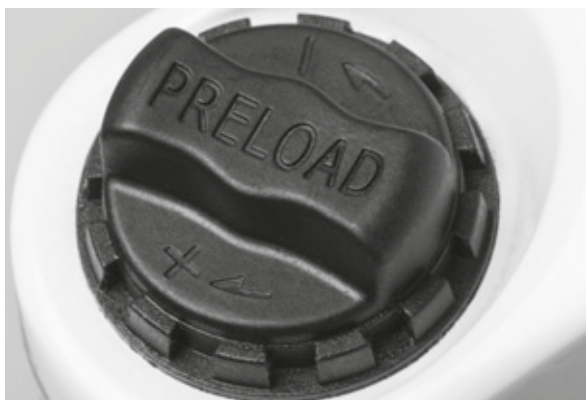
Figura 43: Manopola di regolazione dell'escursione negativa della sospensione sulla corona della forcella ammortizzata
