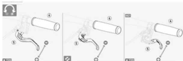
Figura 41: Regolazione dell'ampiezza di presa della leva del freno Magura con freno a disco
