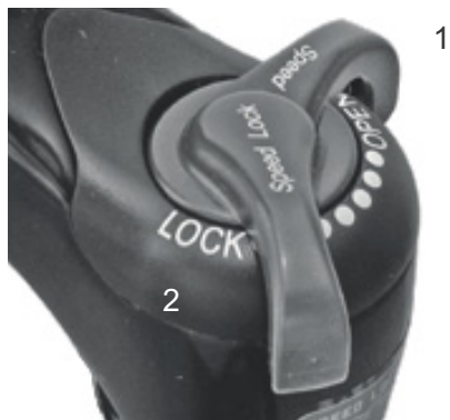
Afbeelding 80: Suntour-drukdemperafsteller met de standen OPEN (1) en LOCK (2)
