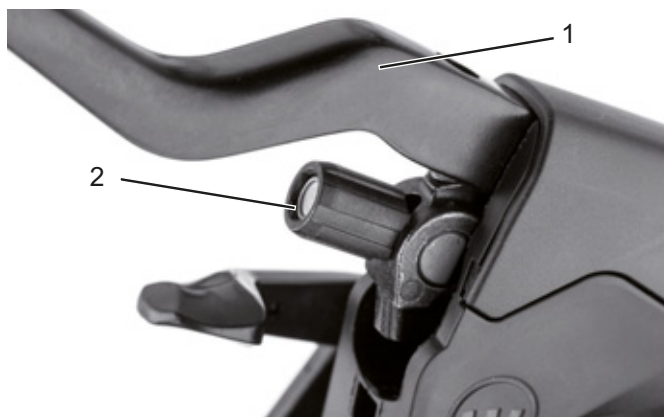
Rysunek 67: Dźwignia (1) hydraulicznego hamulca obręczowego ze śrubą nastawczą (2)
