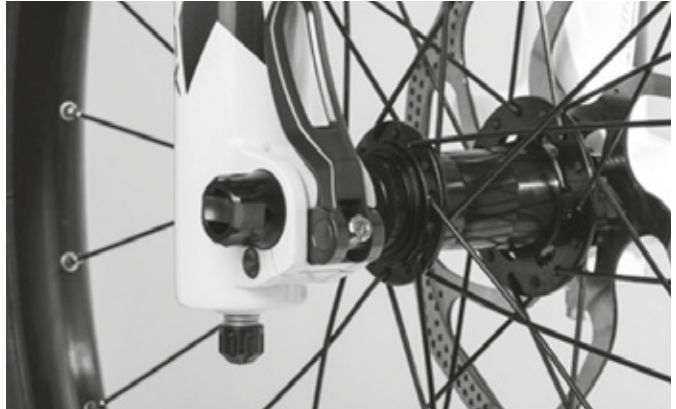
Ustawianie siły mocowania zacisku szybkomocującego
