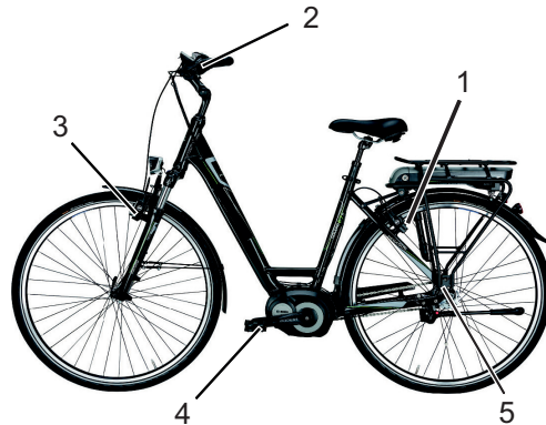
Abbildung 12: Bremssystem eines Fahrrads mit einer Rücktrittbremse, Beispiel
