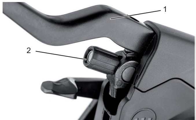
Abbildung 55: Bremshebel (1) der hydraulisch betätigten Felgenbremse mit Einstellschraube (2)
