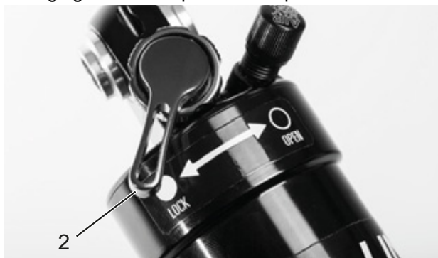
Illustration 80 : Dispositif de réglage de la compression Suntour fermé (2)
