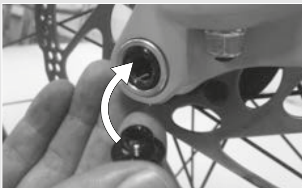
Illustration 28 : Enfoncer le levier d'attache rapide dans l'axe
