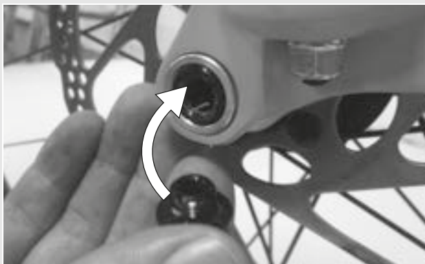
Illustration 32 : Enfoncer le levier d'attache rapide dans l'axe
