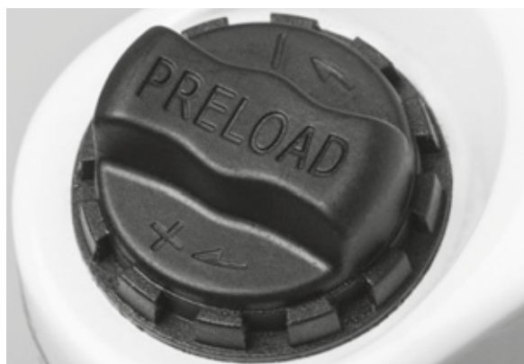
Illustration 61 : Molette de réglage de la course de suspension négative sur la couronne de la fourche de suspension
