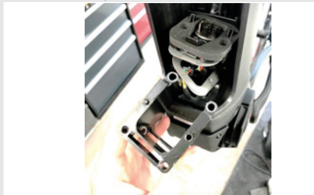
Illustration 27 : Retirer l'adaptateur PowerTube
