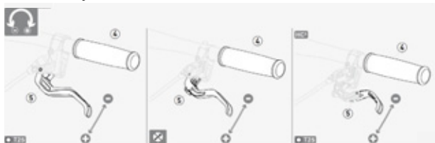
Illustration 59 : Régler la garde d'un levier de frein à disque Magura
