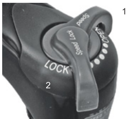
Illustration 72 : Dispositif de réglage de la compression Suntour avec les positions OPEN (1) et LOCK (2)
