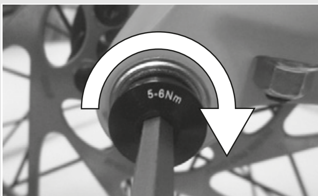
Illustration 33 : Serrer la vis de blocage
