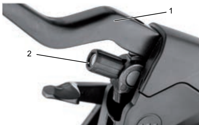
Illustration 65 : Levier de frein (1) du frein de jante à actionnement hydraulique avec vis de réglage (2)
