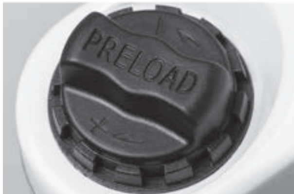
Illustration 44 : Molette de réglage de la course de suspension négative sur la couronne de la fourche de suspension
