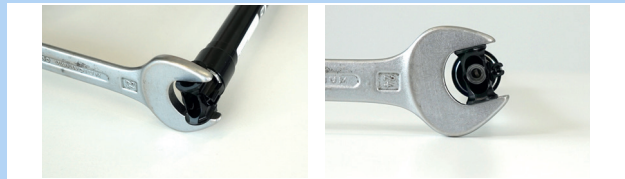
Abbildung 162: Gegen Verdrehen sichern
