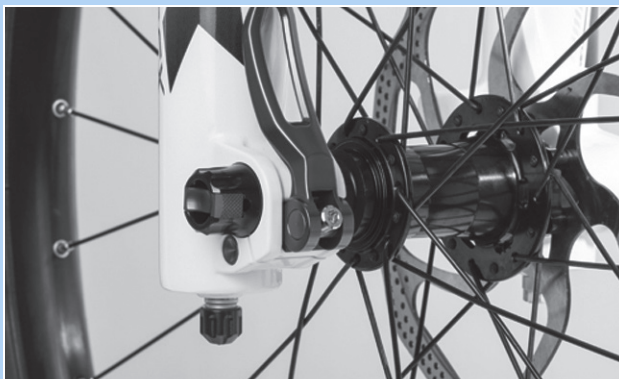
Abbildung 138: Spannkraft des Schnellspanners einstellen
