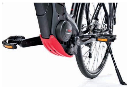
Vorbildlich & auffällig: Motor-Rammschutz.
