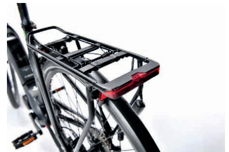
Der mehrfach am Rahmen fixierte Gepäckträger besitzt ein integriertes Rücklicht.
