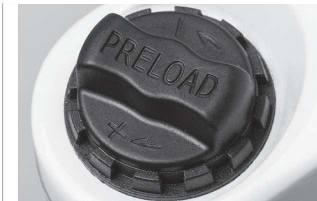
Afbeelding 47: Afstelwiel voor de negatieve veerweg op de kroon van de verende voorvork
